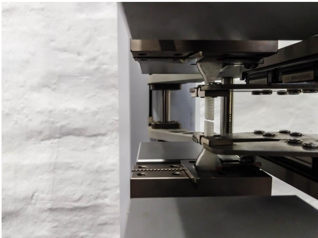
Slika 8: Epruveta nakon pucanja
