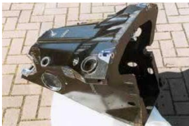
Slika 26 Kućiše od ugljičnih vlakana tima Arrows Formule 1, 1998. [29]
