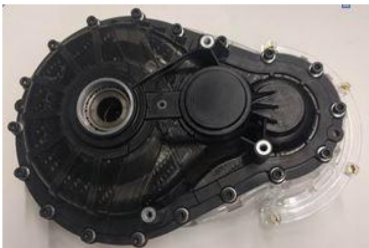
Slika 28 Prototipno kompozitno kućište s aluminijskim umetcima [31]
