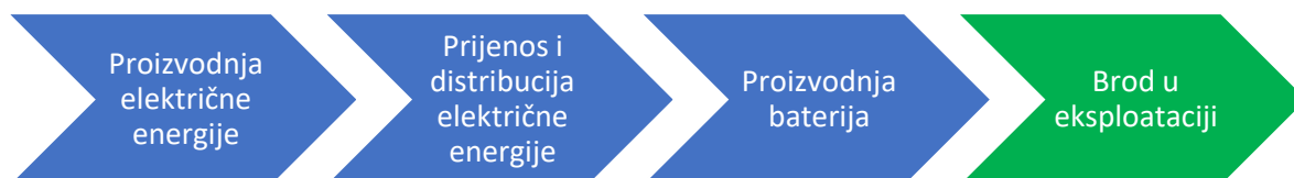
Slika 18. Životni ciklus brodske energetske konfiguracije s litij ionskom baterijom [7]
