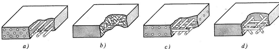
Slika 3.3. Orijentacija vlakana: a) kontinuirana usmjereni vlakna, b) slučajno usmjereni diskontinuirana vlakna, c) ortogonalno raspoređena vlakna, d) višesmjerne usmjereni vlakna
