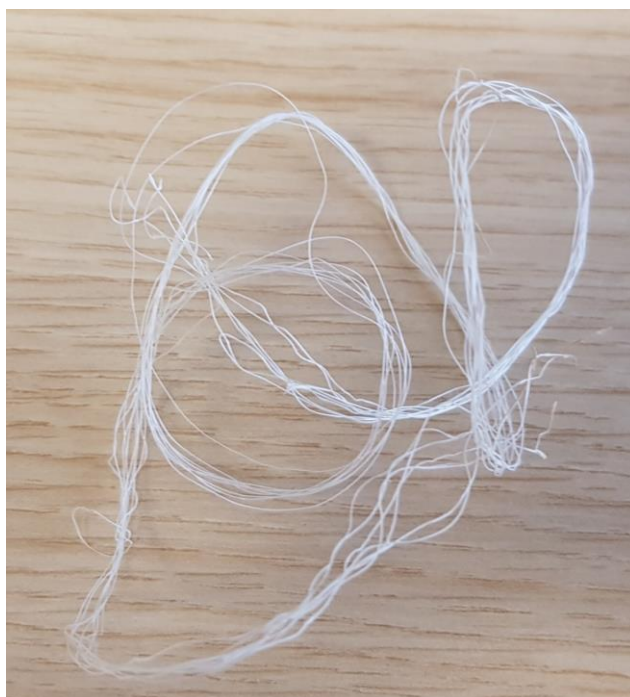
Slika 5.5. Vlakna agave [foto: A. Pilipović]
