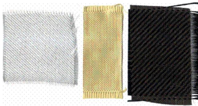
Slika 3.7. Staklena, aramidna i ugljična vlakna [10]
