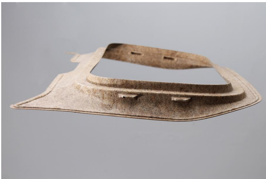
Slika 9.5. Krovni okvir automobila od prirodnih vlakana [75]
