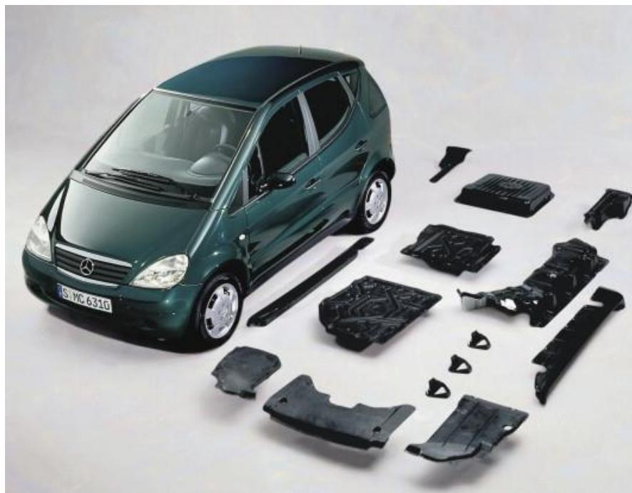
Slika 5.10 Donji dijelovi automobila ojačani lanenim vlaknima [28]
