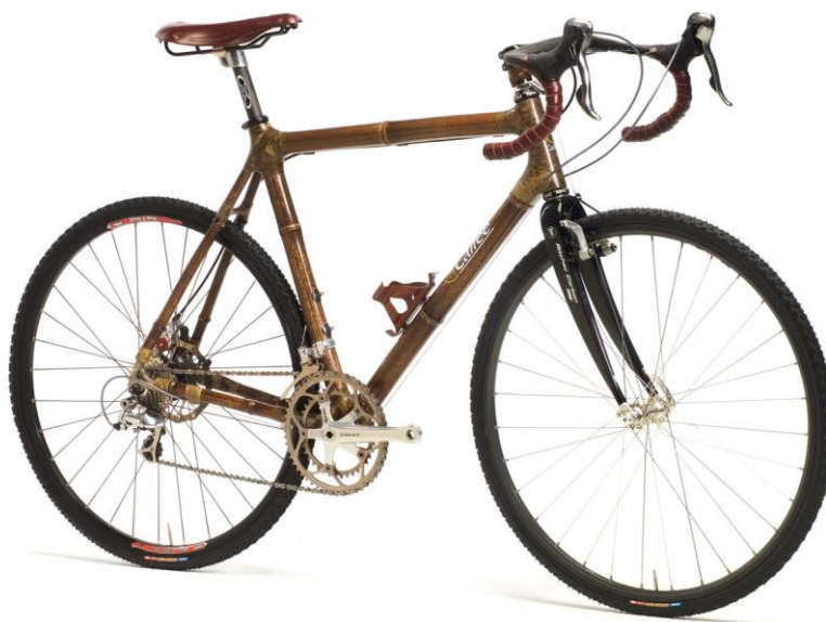
Slika 9.8. Bicikl od bambusa [79]
