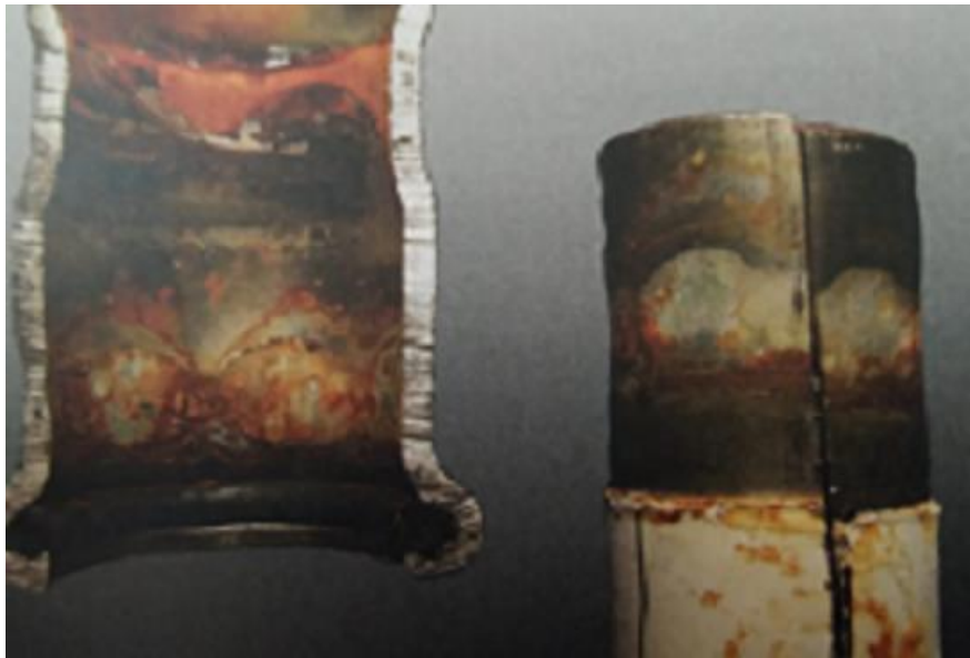
Slika 49. Korozija u procijepu nastala zbog djelovanja bakterija [1]
