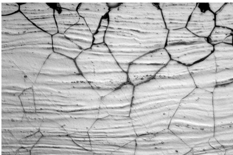
Slika 21. Oštećenje područja zavarenog spoja nastalo djelovanjem interkristalne korozije [27]
