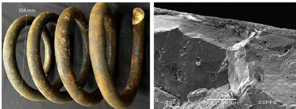
Slika 47. Pojava vodikove krhkosti uslijed djelovanja sulfat-reducirajućih bakterija na opruzi ventila [37]
