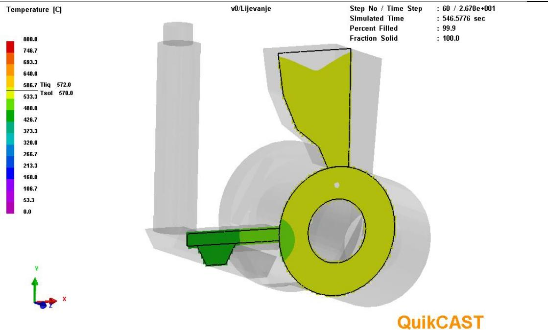
**Slika 60. Temperatura odljevka i uljevnog sustava na završetku skrućivanja**
