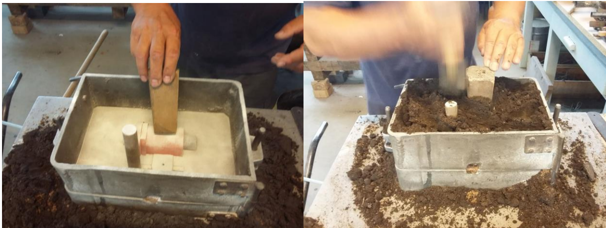
Slika 41. Namješavanje pojila, zasipanje kalupnom mješavinom i sabijanje
