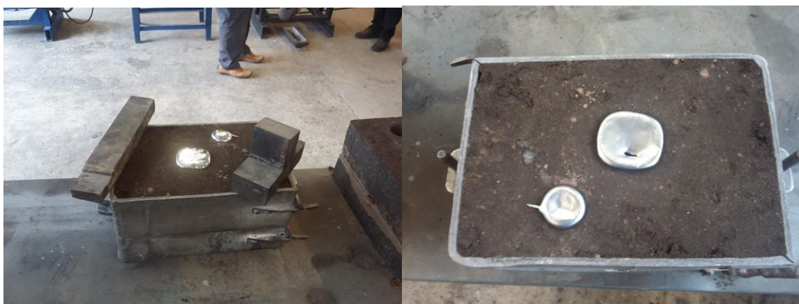
Slika 53. Skrućivanje metala u kalupu
