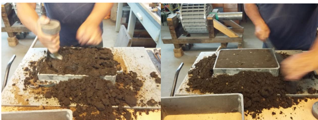
Slika 39. Dodavanje punidbene kalupne mješavine, njezino sabijanje i poravnavanje
