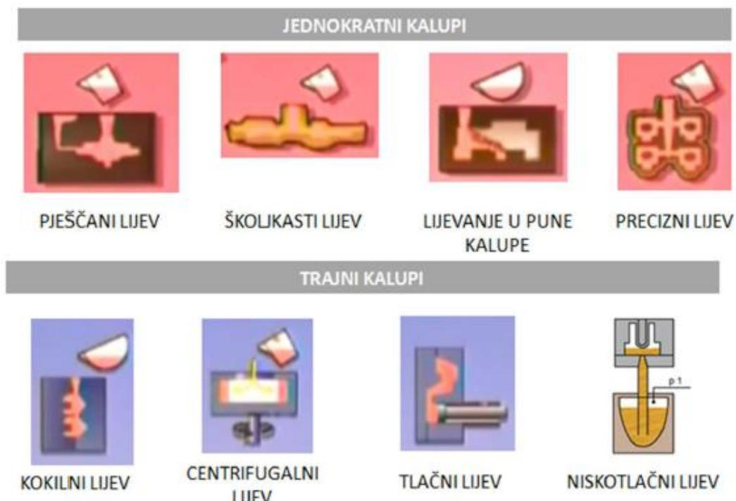
Slika 2. Podjela jednokratnih i trajnih kalupa [1]
