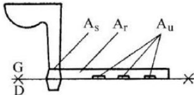
Slika 19. Tlačni uljevni sustav [1]
