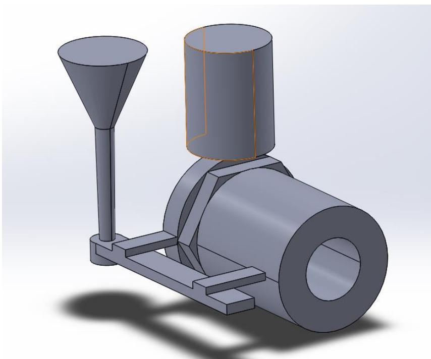
Slika 28. Uljevni sustav i odljevak s jednim pojilom
