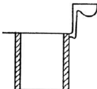
Slika 16. Direktni uljevni sustav s ušćem odozgo [1]
