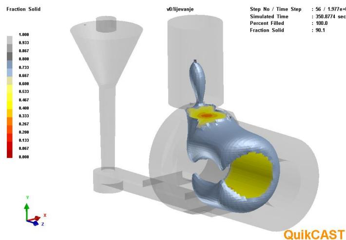
**Slika 33. Prestanak napajanja odljevka s jednim pojilom**
