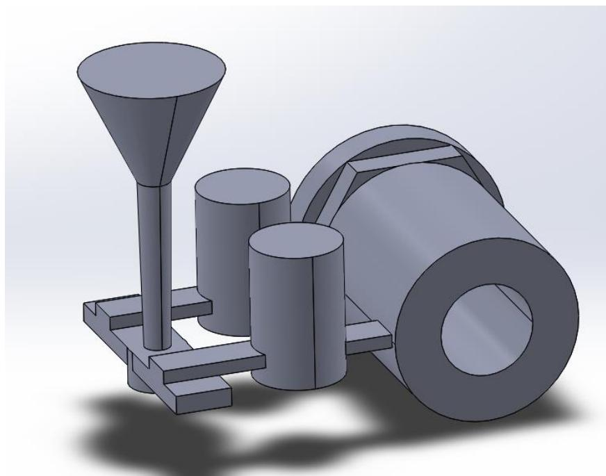
**Slika 29. Uljevni sustav i odljevak s dva pojila**
