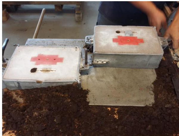
Slika 44. Gornjak i donjak prije vađenja modela, razvodnika i ušća
