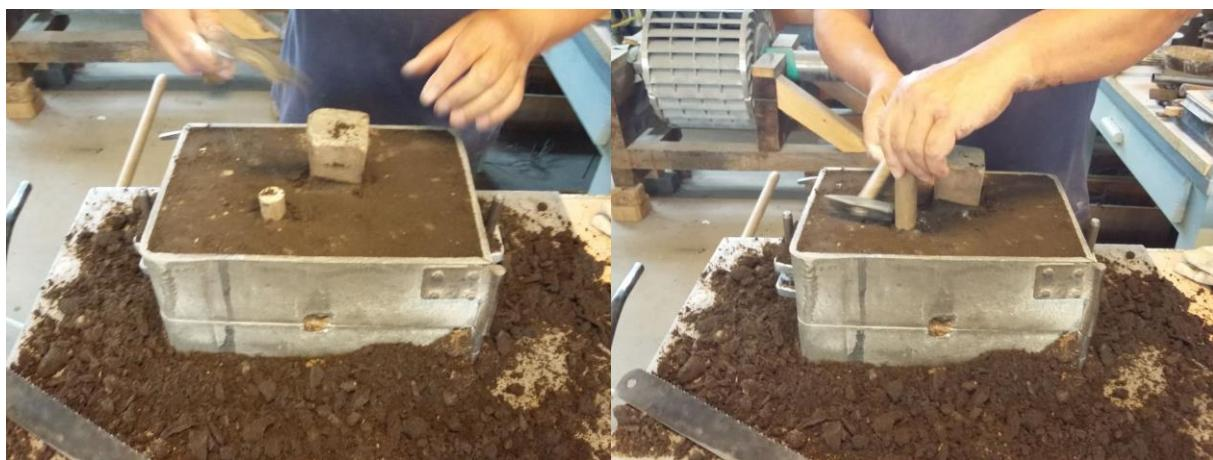
Slika 42. Poravnavanje kalupne mješavine i vadenje dijelova uljevnog sustava iz gornjaka
