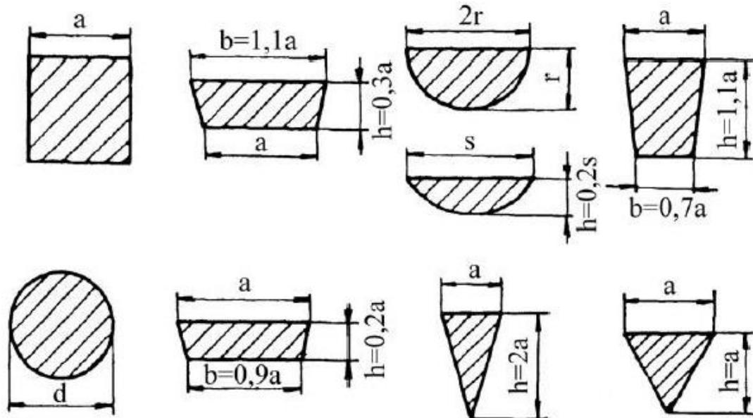
Slika 15. Poprečni presjeci ušća [1]
