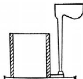
**Slika 18. Uljevni sustav s ušćem odozdo [1]**
