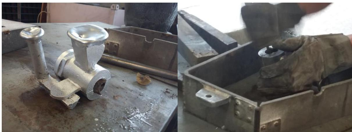
Slika 55. Odljevak izvađen iz kalupa i razrušivanje jezgre
