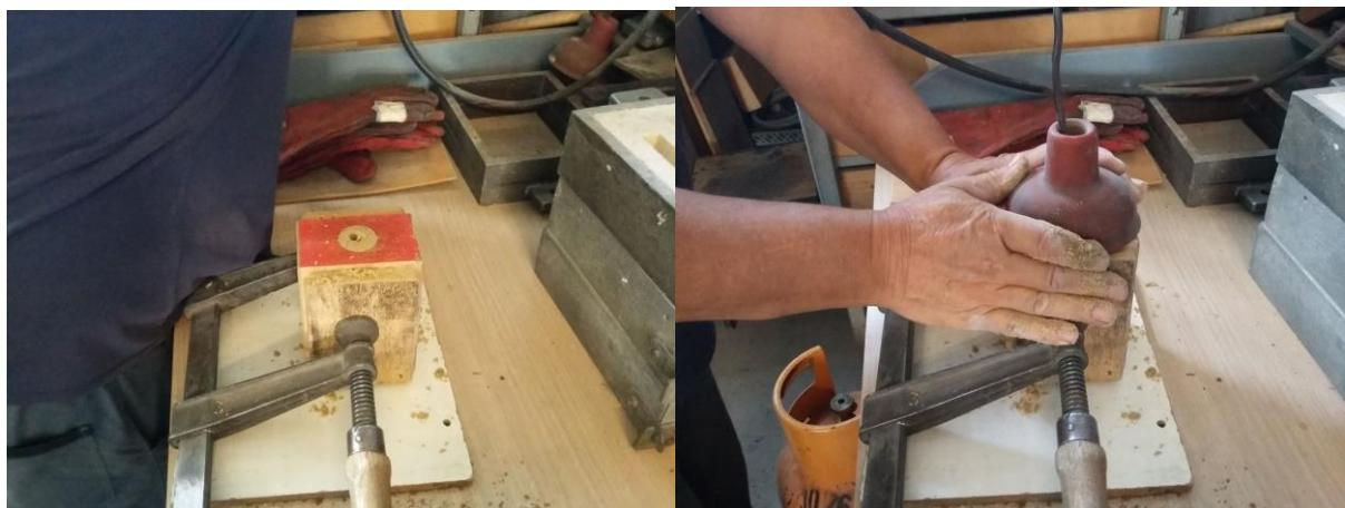
Slika 47. Propuhivanje jezgre plinom CO<sub>2</sub> radi očvrsnoga
