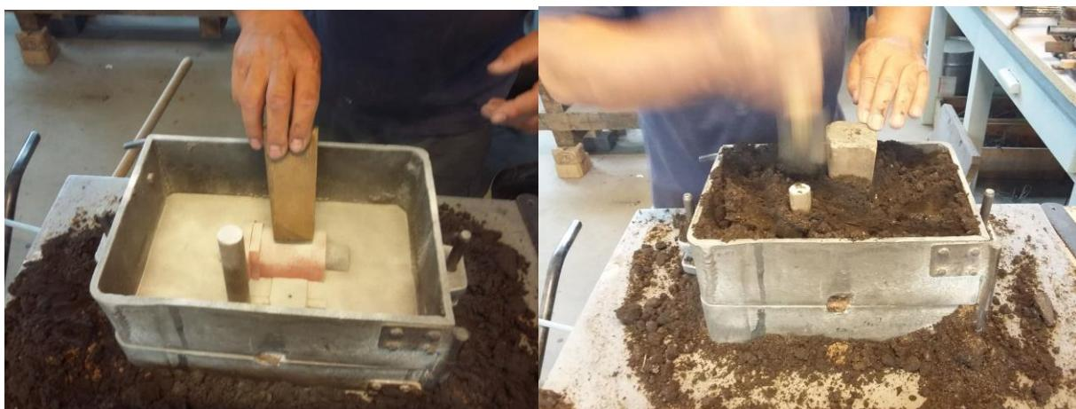
Slika 41. Namještavanje pojila, zasipanje kalupnom mješavinom i sabijanje
