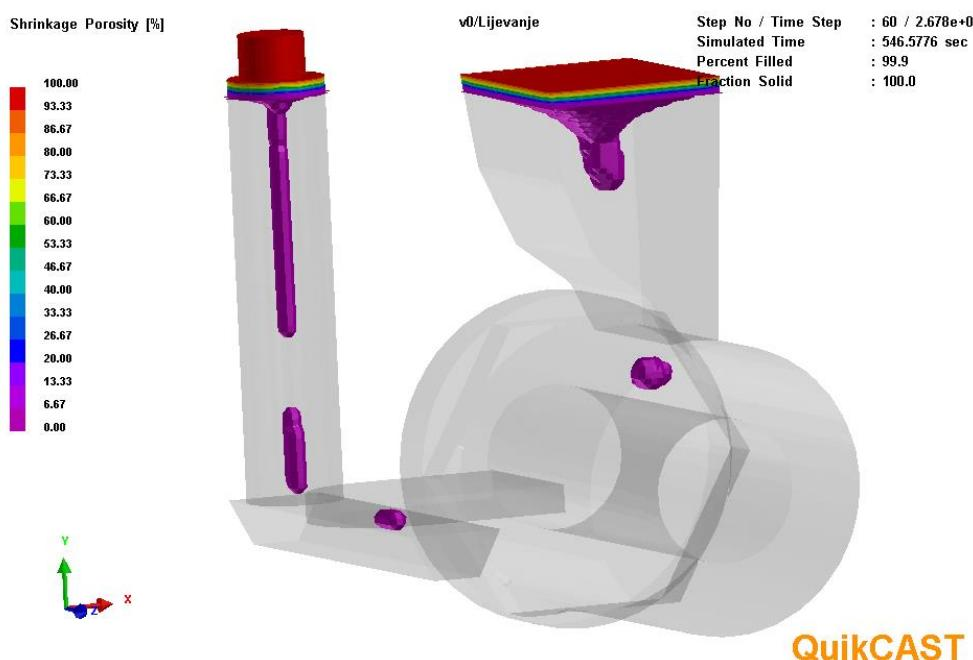
**Slika 59. Mesta nastanka poroznosti na odljevku i uljevnom sustavu**
