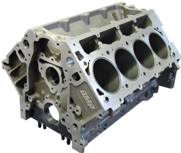
**Slika 24. Blok motora od lijevane aluminijске legure [9]**
