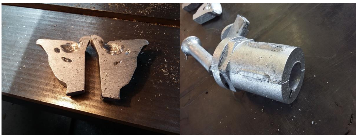
Slika 57. Razrezano pojilo s poroznošću i završni izgled odljevka
