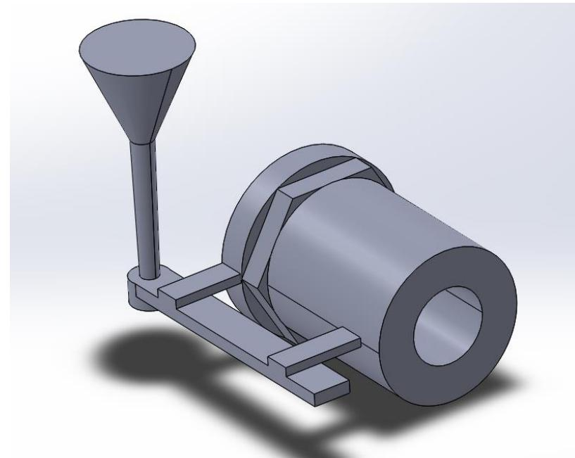
Slika 27. Uljevni sustav i odljevak bez pojila
