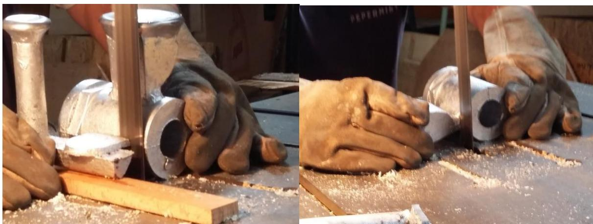
Slika 56. Razdvajanje odljevka od uljevnog sustava i sustava napajanja
