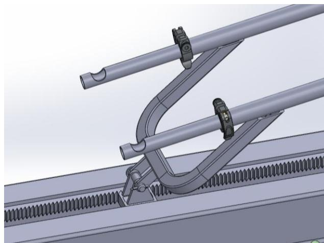
**Slika 34.** Veza nosive konstrukcije sa samokočnim mehanizmom
