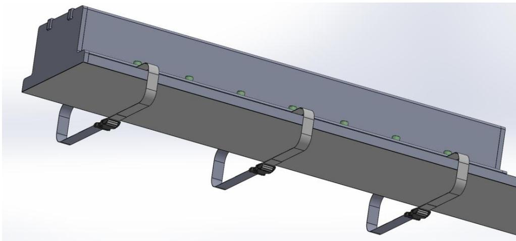
Slika 22. Podsustav za prihvatanje uređaja na podlogu
