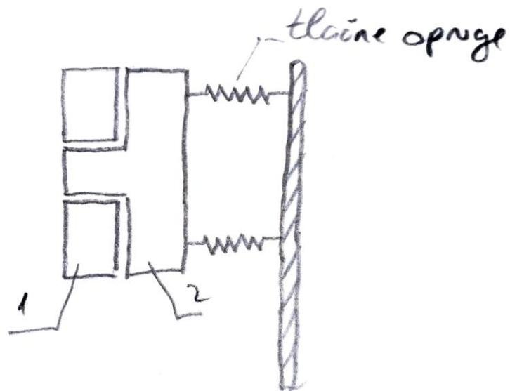
**Slika 16. Princip uklanjanja samokočnog djelovanja u konceptu 2**
