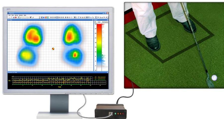
Slika 30. Tactilus® Body Mapping Sensor System [18]
