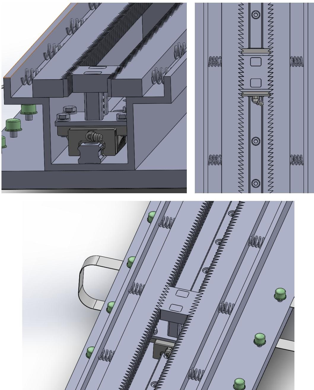
Slika 24. Samokočni mehanizam
