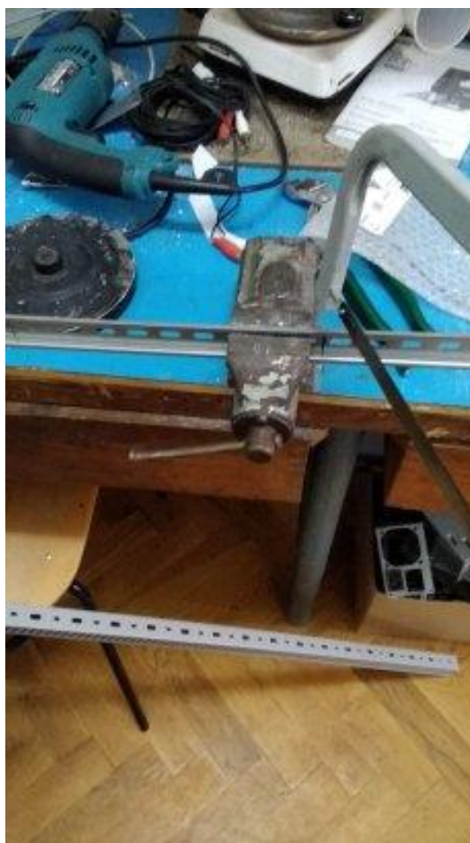
Slika 27. Piljenje montažnih nosača
