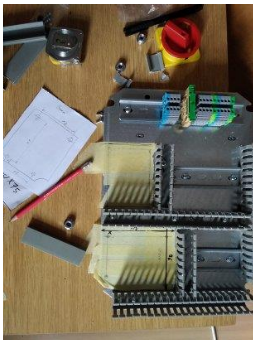
Slika 29. Montiranje uzdužnih kabelskih kanala
