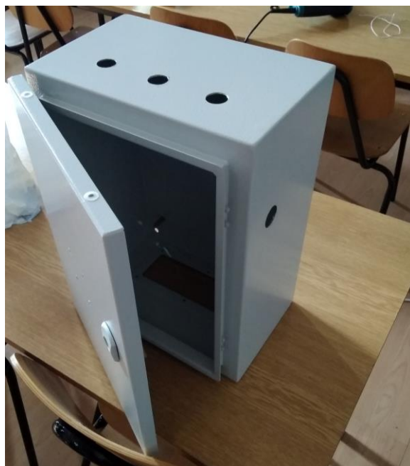
Slika 31. Probušene rupe u razvodnom ormaru
