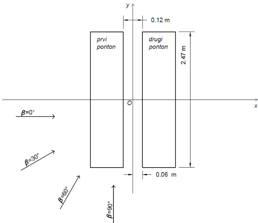
Slika 9. Dimenzije pontona *pntM06P06*
