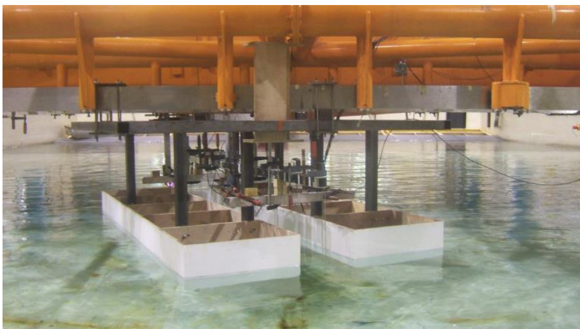
Slika 7. Modeli pontona u bazenu [6]
