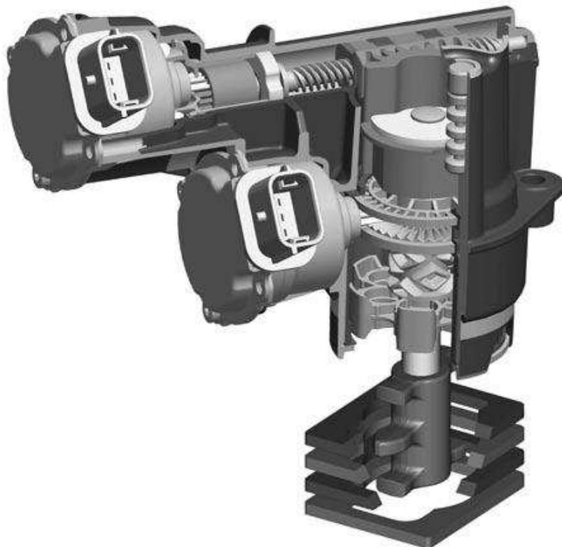
Slika 6.1: Aktuator izmjene stupnjeva prijenosa [4].
