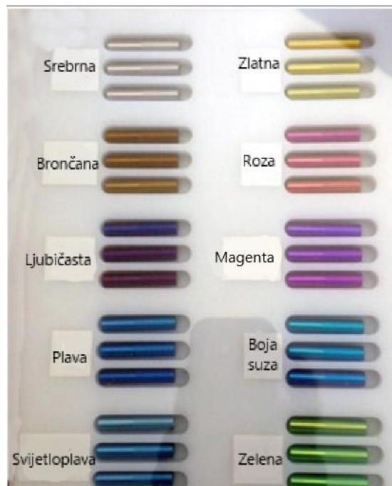
Slika 22. Uzorci dostupnih boja titanijskih tipova 3 kod anodiziranja tipa 3 [23]
