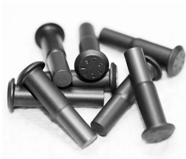
Slika 21. Titanij anodiziran tipom 2 [24]
