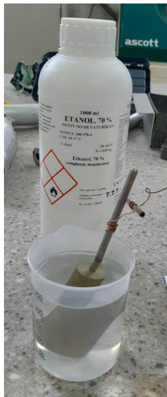
Slika 28. Odmašćivanje uzorka u 70 % - tnom etanolu
