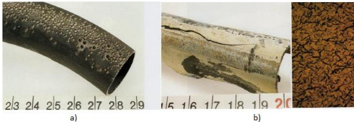
Slika 20. a) rupičasta korozija, b) opća korozija [21]
