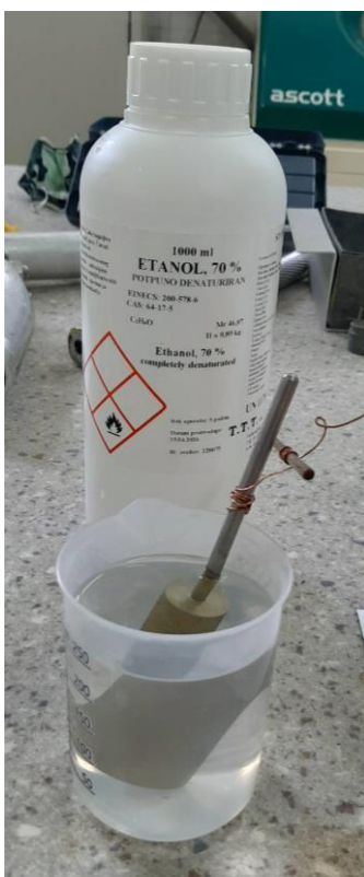
Slika 28. Odmašćivanje uzorka u 70 % - tnom etanolu
