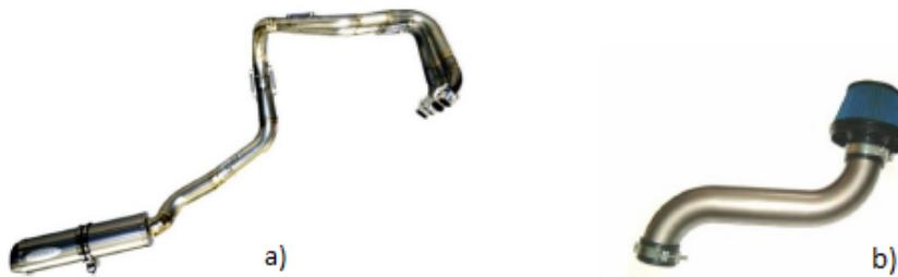
Slika 11. a) ispušni sustav, b) usisni sustav [2]
