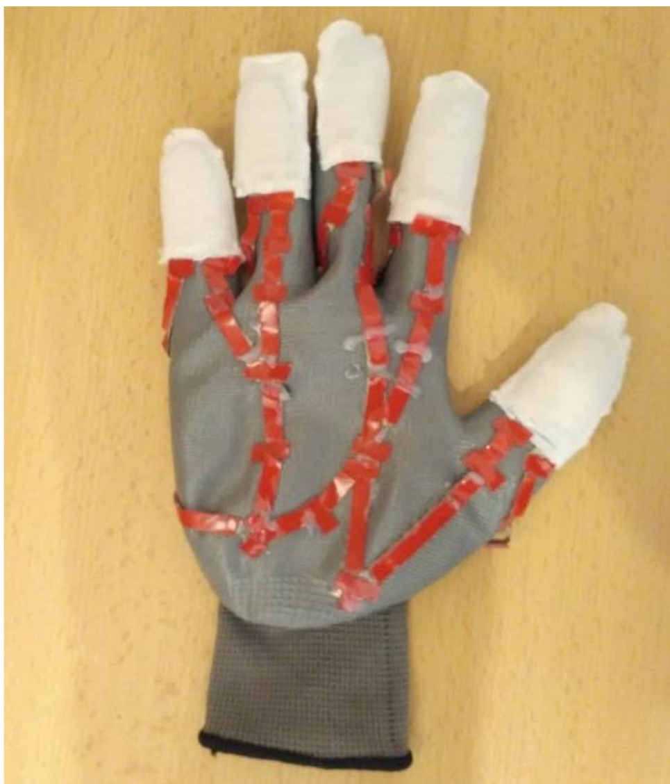
Slika 8. Rukavica sa postavljenim senzorima
