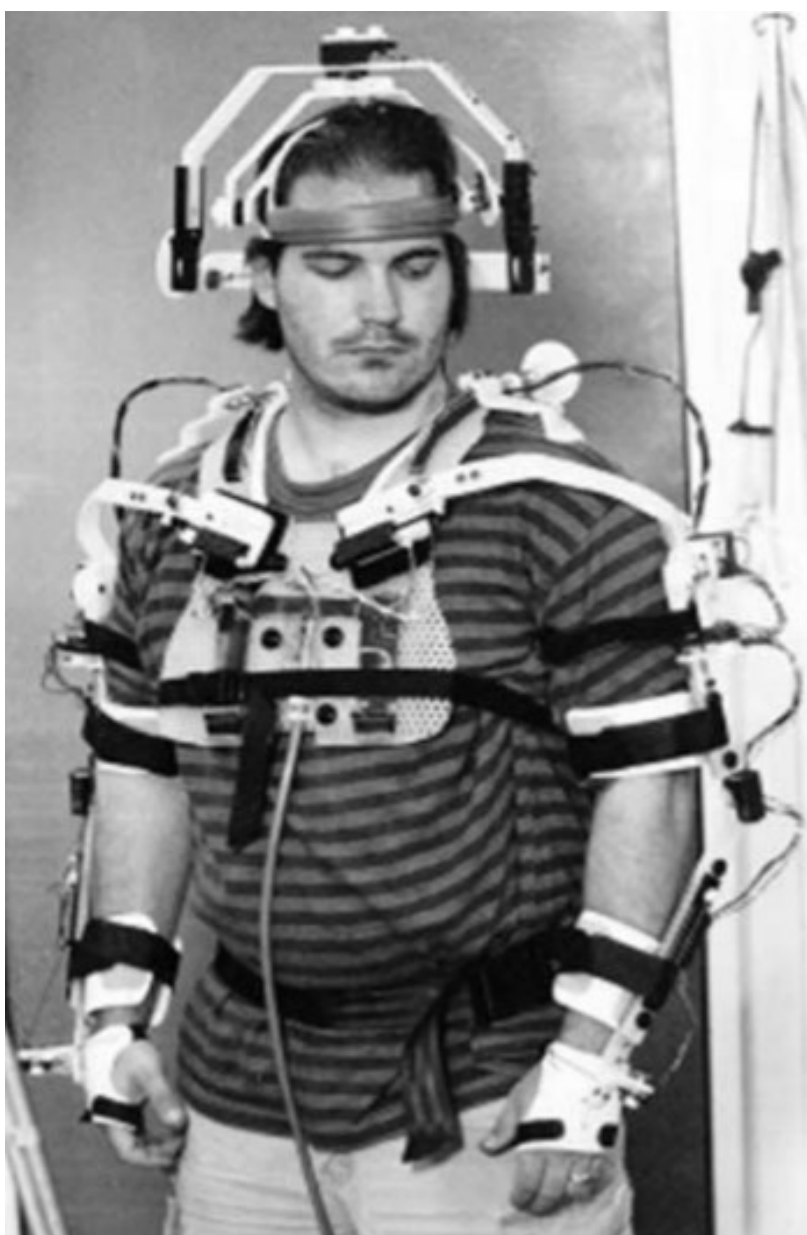
Slika 3. Calvertov mehanički egzoskeleton [9]
