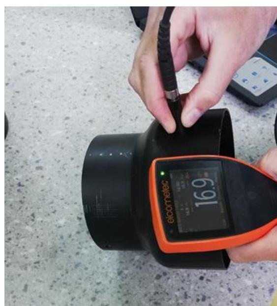
Slika 21. Prikaz tehnike mjerena pomoću „Elcometer 456“
