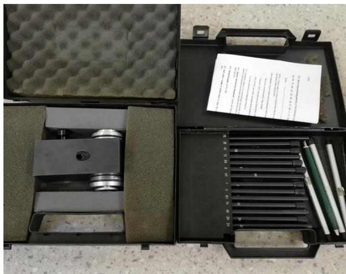
Slika 22. Pribor za mjerjenje tvrdoće premaza
