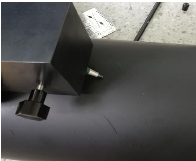
Slika 23. Način provođenja ispitivanja tvrdoće
