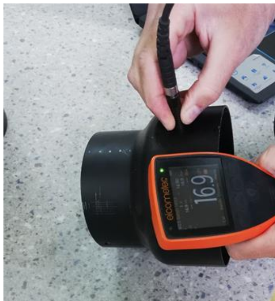
Slika 21. Prikaz tehnike mjerenja pomoću „Elcometer 456“
