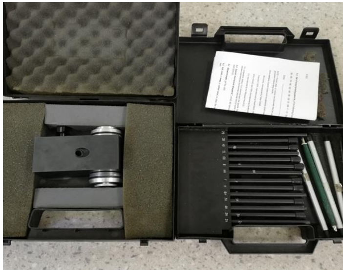
Slika 22. Pribor za mjerenje tvrdoće premaza
