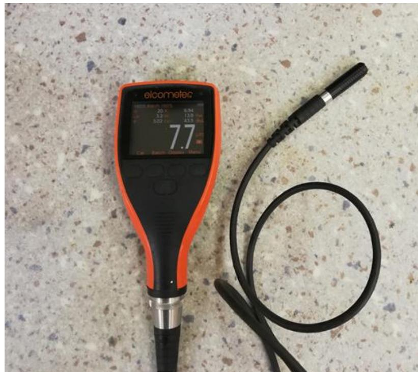
Slika 20. Uredaj za mjerjenje debljine premaza „Elcometer 456“
