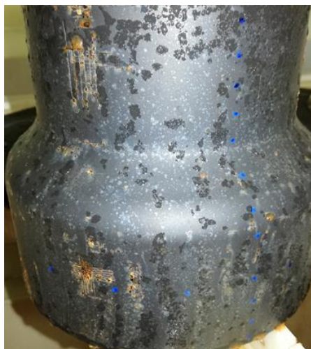
Slika 15. Uzorak broj 1 nakon vlažne komore
