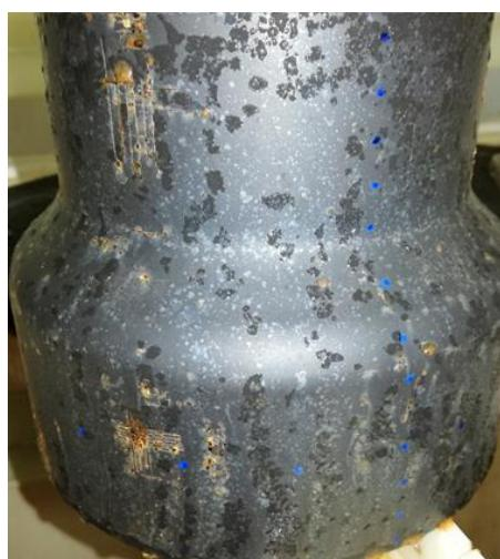
**Slika 15. Uzorak broj 1 nakon vlažne komore**
