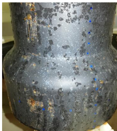
Slika 15. Uzorak broj 1 nakon vlažne komore
