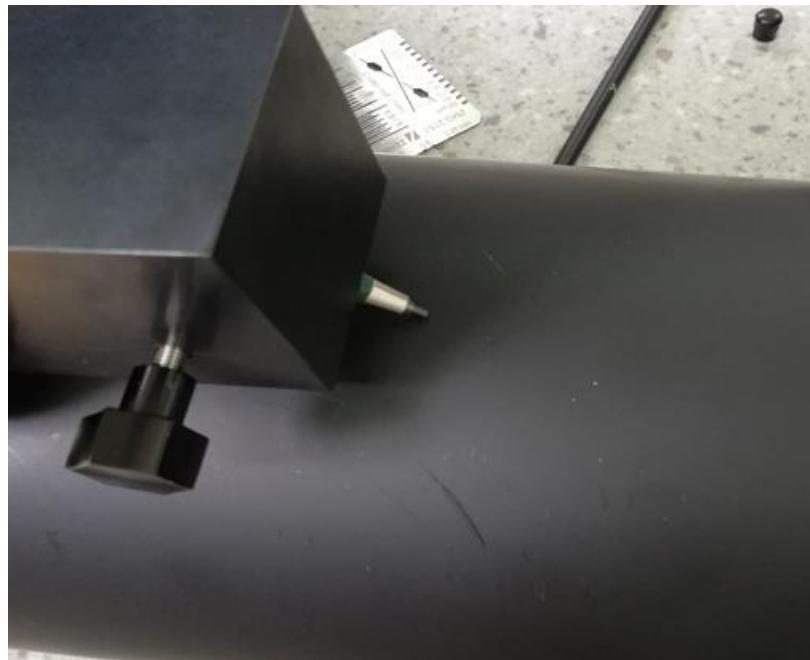
**Slika 23. Način provođenja ispitivanja tvrdoće**
