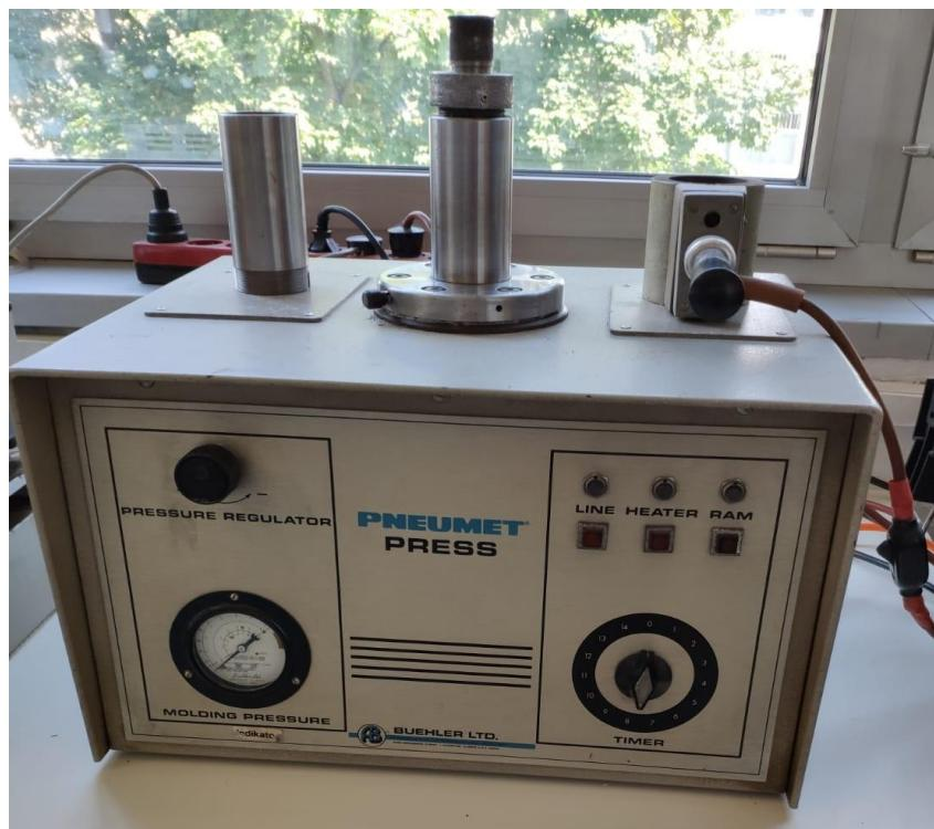
Slika 25. Preša za zalijevanje uzorka
