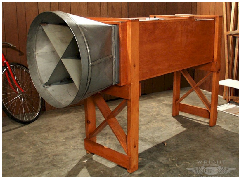
Slika 1. Zračni tunel braće Wright [1]
