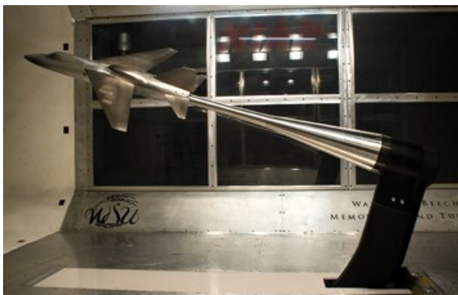
Slika 8. Mjerenje aerodinamičkih naprezanja unutarnjom vagom [9]
