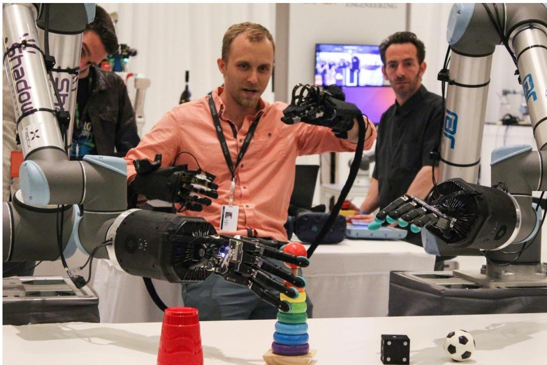
Slika 17. Teleoperacija robota podatkovnim rukavicama [15]
