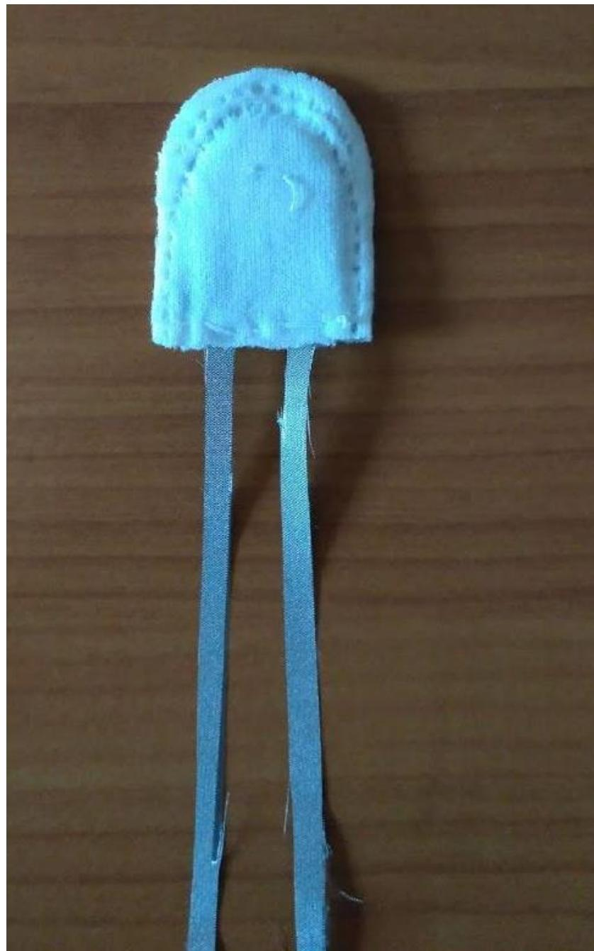
Slika 23. Taktilni senzor [22]
