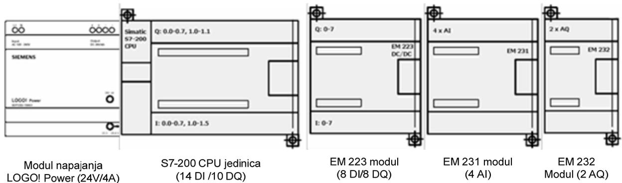
**Slika 2.3 Shematski prikaz komponenti makete**
