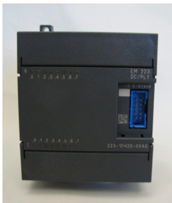
Slika 2.5 Ekstenzijski modul EM 223
