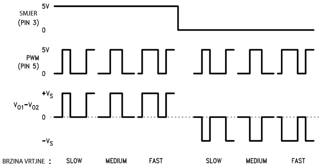
**Slika 3.15 Ulazno izlazna karakteristika LM18200T**
