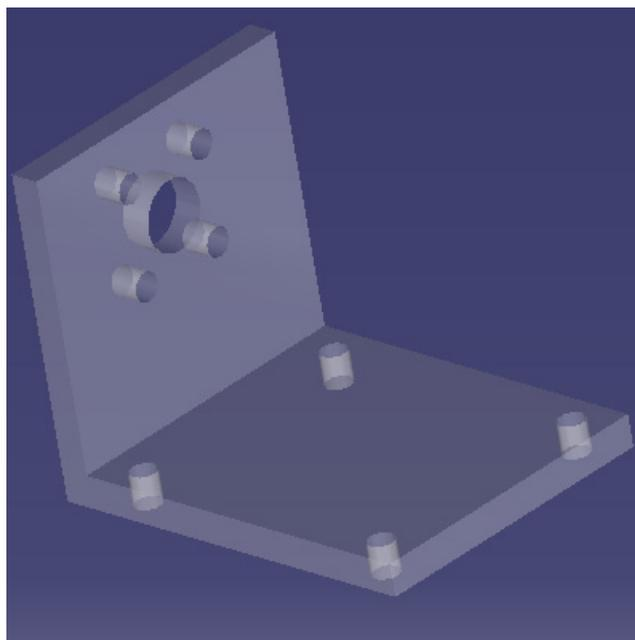
**Slika 3.9 Nosač motora**
