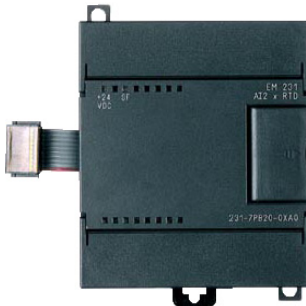
Slika 2.6 Ekstenzijski modul EM 231
