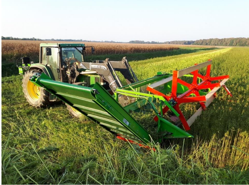
Slika 21. Berač za branje konoplje sastavljen od motovila, kose i trakastih transportera
