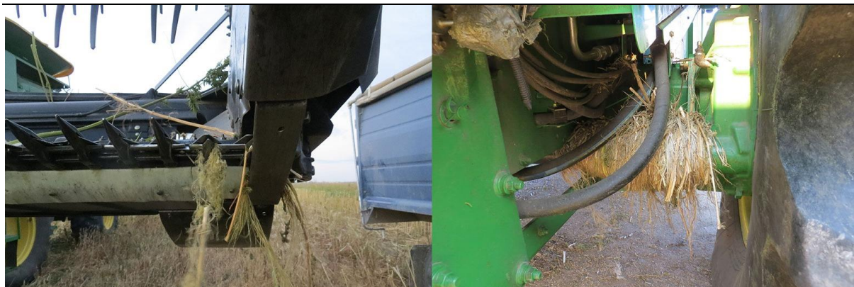
Slika 12., Zaplitanje oko noževa (lijevo) i vratila kotača kombajna (desno)
