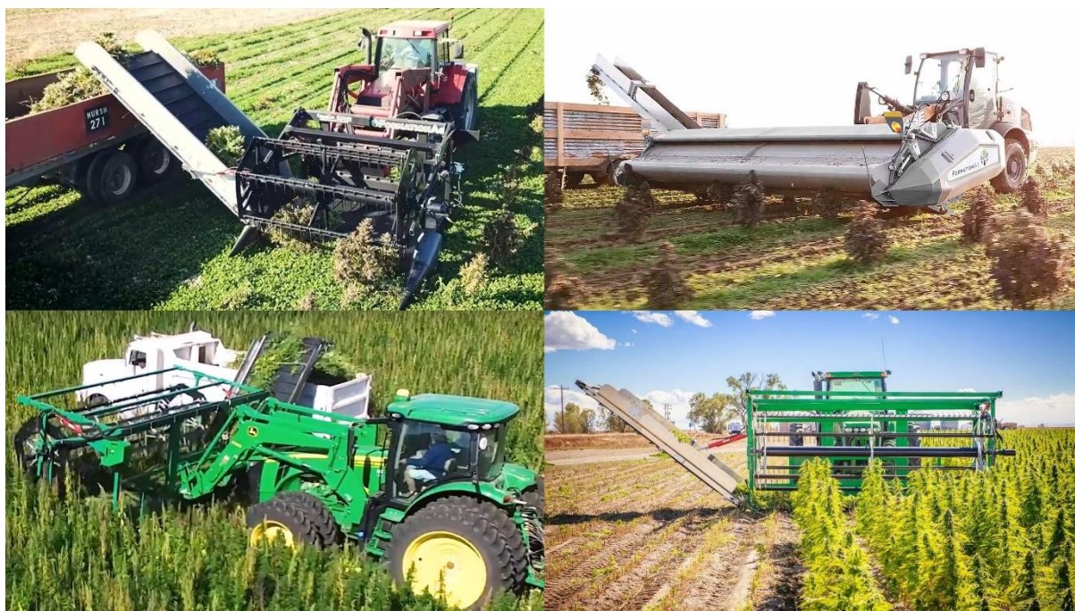
Slika 15. Razne verzije CleanCut Headera i CleanStripa u širokorednom i uskorednom tipu uzgoja
