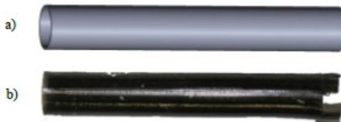
Slika 6. a) CAD model uzorak, b) ispisani model[16]
