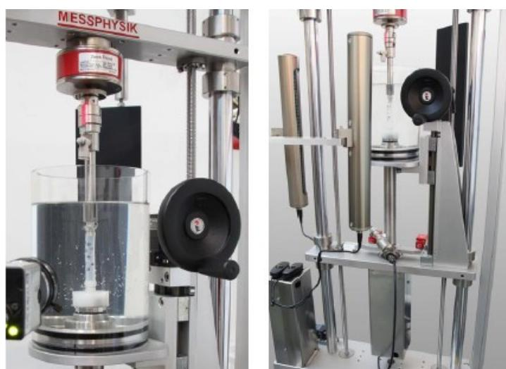
Slika5. Uredaj za test tlak – istezanje[16]
