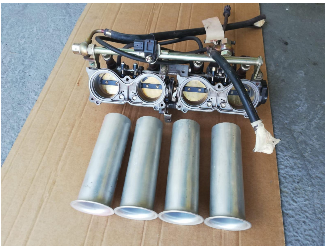
Slika 3.2. Usisna tijela sa Honde CBR1000RR i usisne trubice
