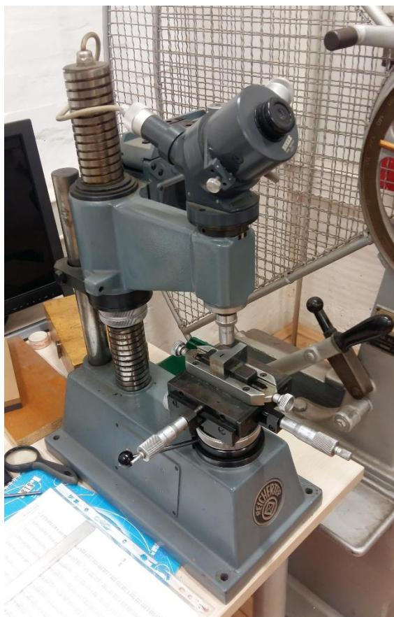
Slika 56. Tvrdomjer proizvođača *REICHERTER*
