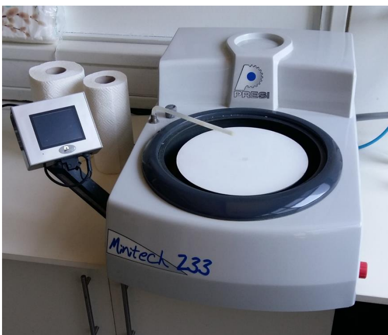
Slika 42. Uređaj za brušenje ispitnih površina Mintech 233 proizvođača Presi
