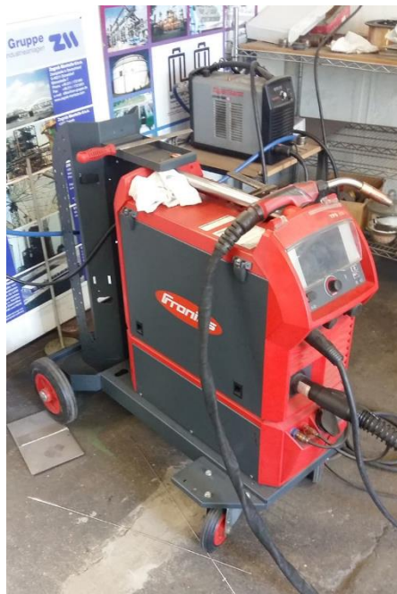
Slika 35. Uređaj za zavaivanje Fronius TPS 320i
