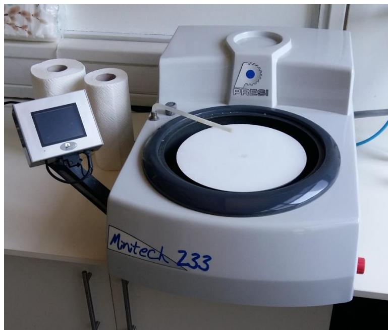
Slika 42. Uređaj za brušenje ispitnih površina *Minitech 233* proizvođača *Presi*
