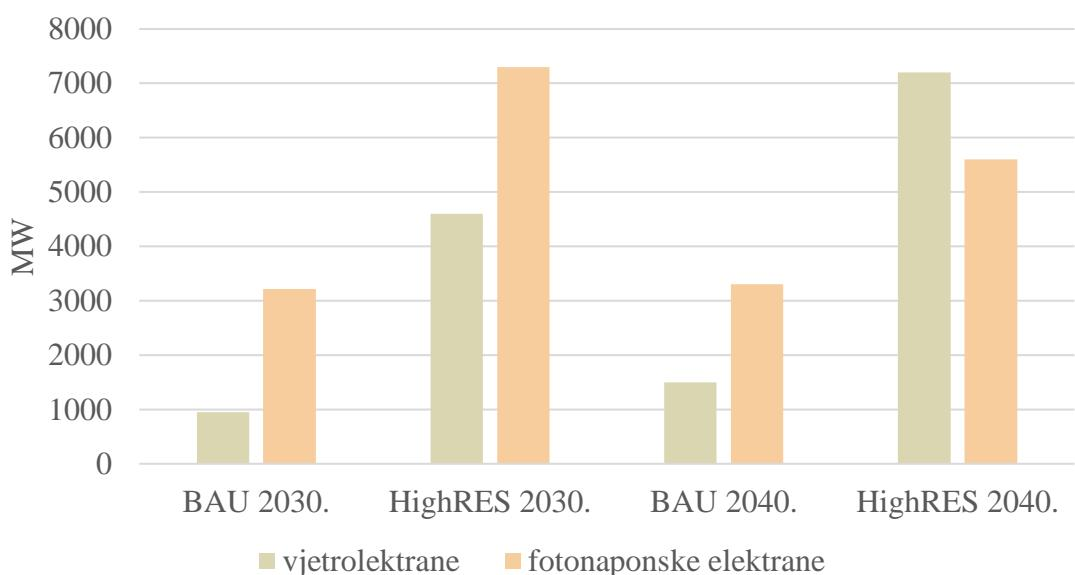
**Slika 16. Instalirani kapaciteti VOIE u BAU i HighRES scenarijima**
