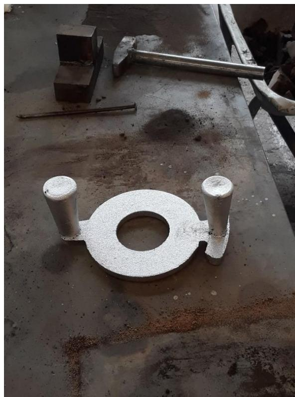
Slika 52. Odljevak s uljevnim sustavom i pojilom.
