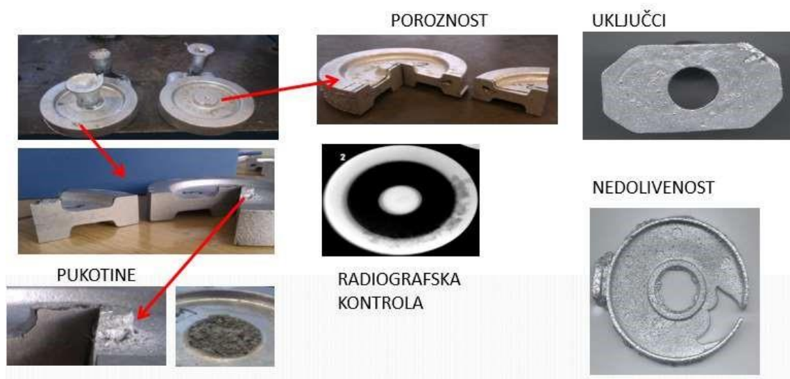
Slika 6. Temeljne pogreške na odljercima. [2]
