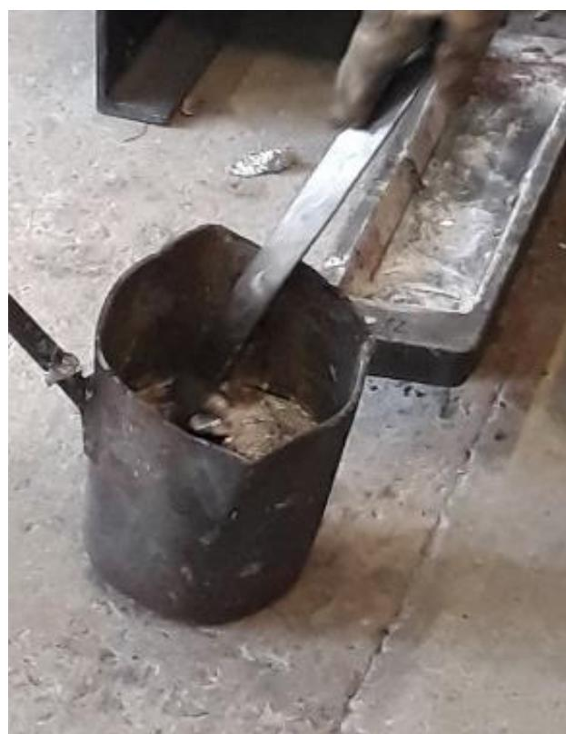
Slika 49. Čišćenje aluminijevih oksida sa površine taljevine.
