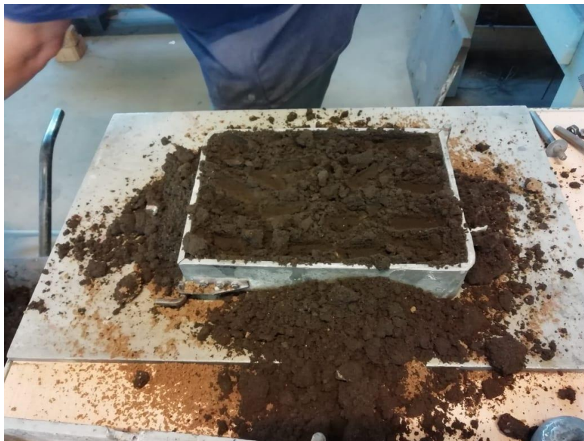
Slika 38. Stavljanje punidbene kalupne mješavine u donjak.
