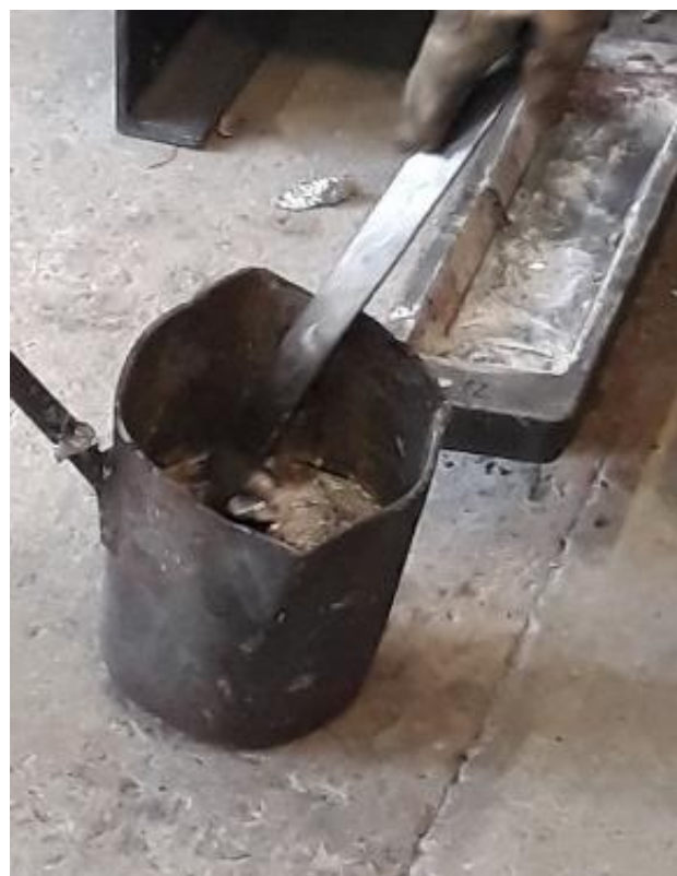
Slika 49. Čišćenje aluminijskih oksida sa površine taljevine.
