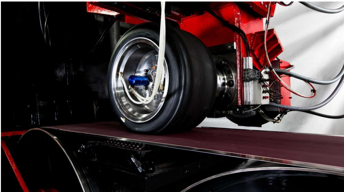
Slika 96. Ispitivanje pneumatika na Calspan ispitnom postavu, [2]
