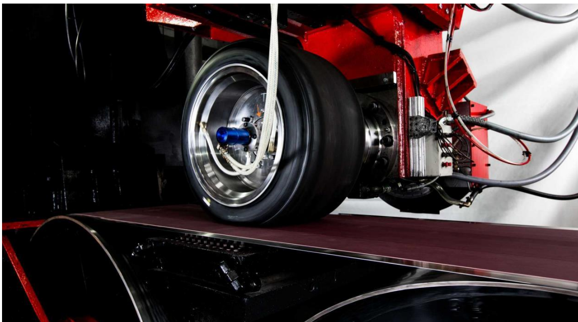
Slika 96. Ispitivanje pneumatika na Calspan ispitnom postavu, [2]
