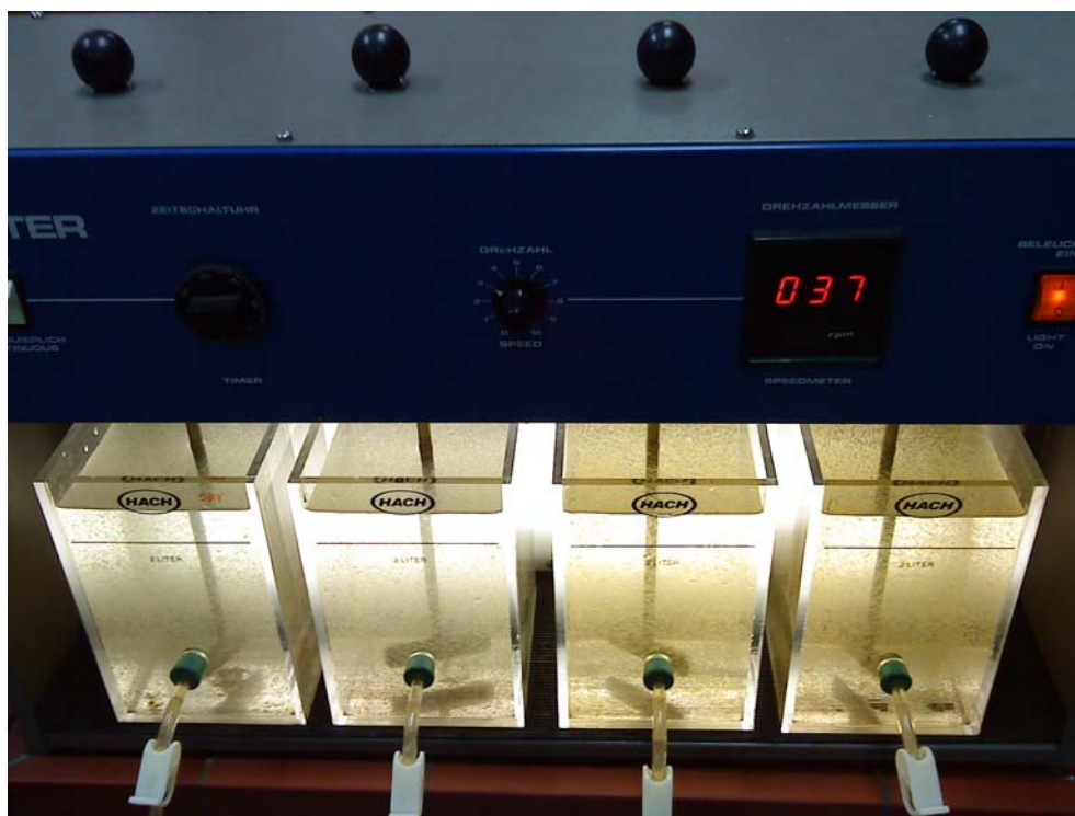
Slika 4. Flokulacija 100 i 200 \mu\text{L} \text{FeCl}_3
