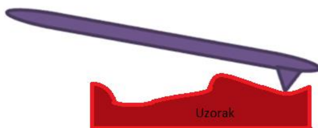
Slika 25. Shematski prikaz kontaktne metode AFM [33]
