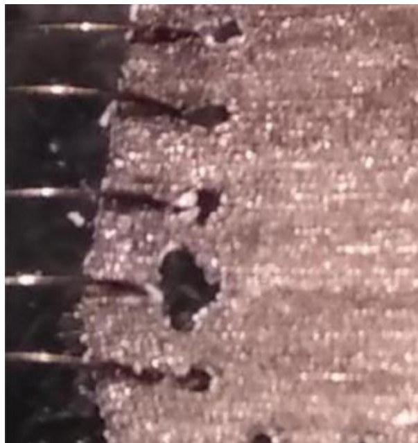
Slika 8. Pucanje uzorka uslijed koncentracije naprezanja
