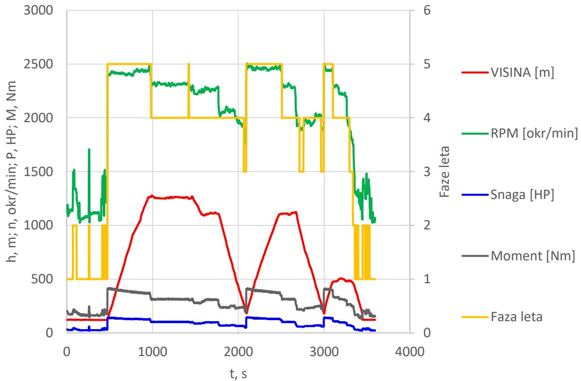
*Slika 3.6. Više komponentni dijagramski prikaz performansi motora, visine i faze leta (faze leta su: 1 – prazni hod, 2 – taksiranje , 3 – slijetanje, 4 – krstarenje, spuštanje, 5 – polijetanje, penjanje)*
