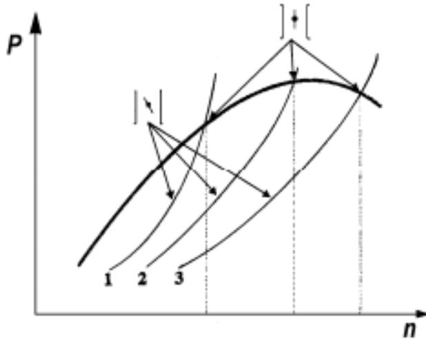
Slika 2.11. Pogon propeleru promjenjive karakteristike (1-teški propeler, 2-propeler koji iskorištava najveću snagu motora, 3-lagani propeler)
