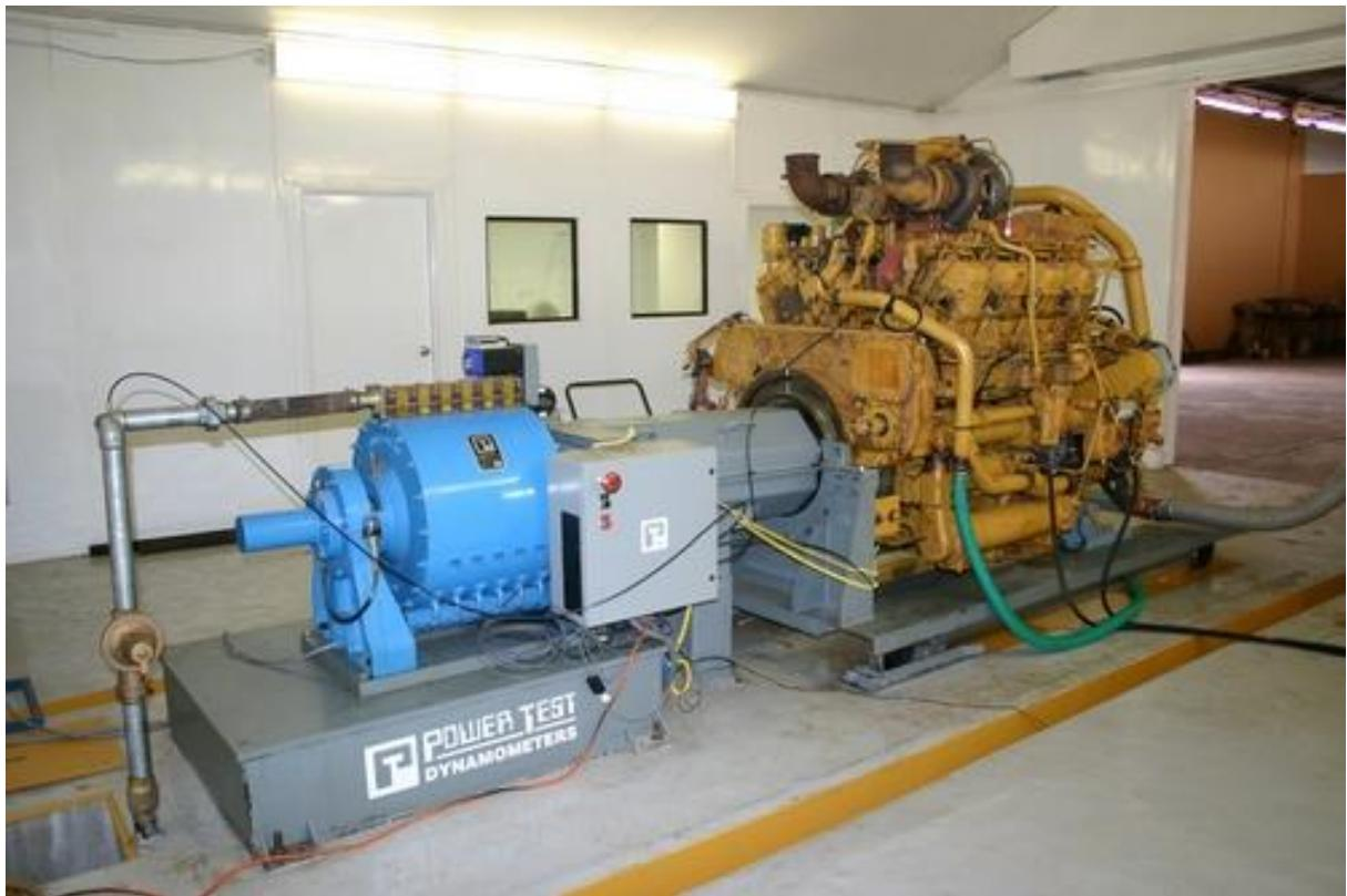
Slika 2.9. Motor priključen na mjernu kočnicu [13]
