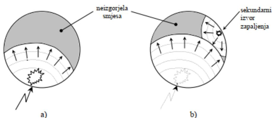
Slika 1.4. Detonacija u cilindru Ottovog motora [1]
