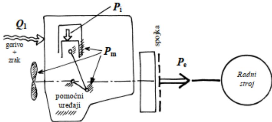
Slika 2.8. Shematski prikaz toka snage u motoru [1]
