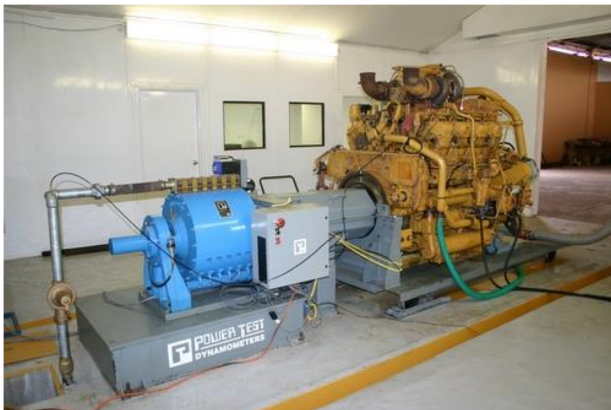
Slika 2.9. Motor priključen na mjernu kočnicu [13]
