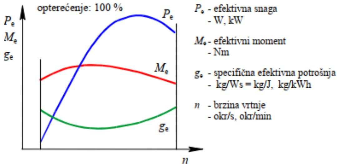
Slika 2.4. Brzinska karakteristika motora pri punom opterećenju [1]
