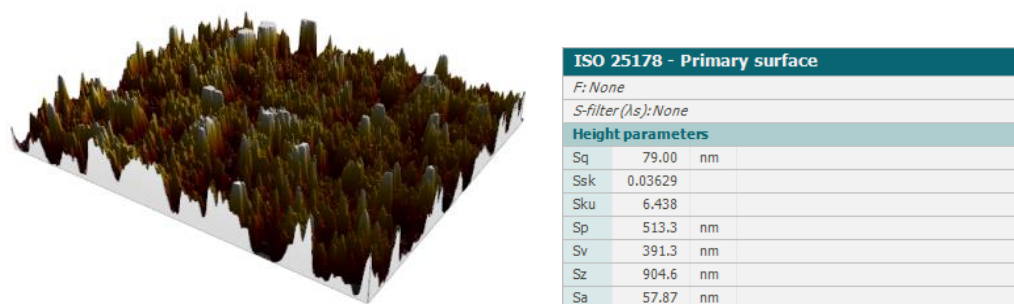
Slika 26. Uzorak 1 – 3D prikazi i 3D parametri topografije
