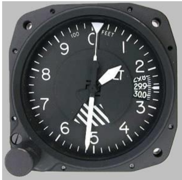
Slika 2.1. Barometarski visinomjer sa podjelom u stopama (feet)
