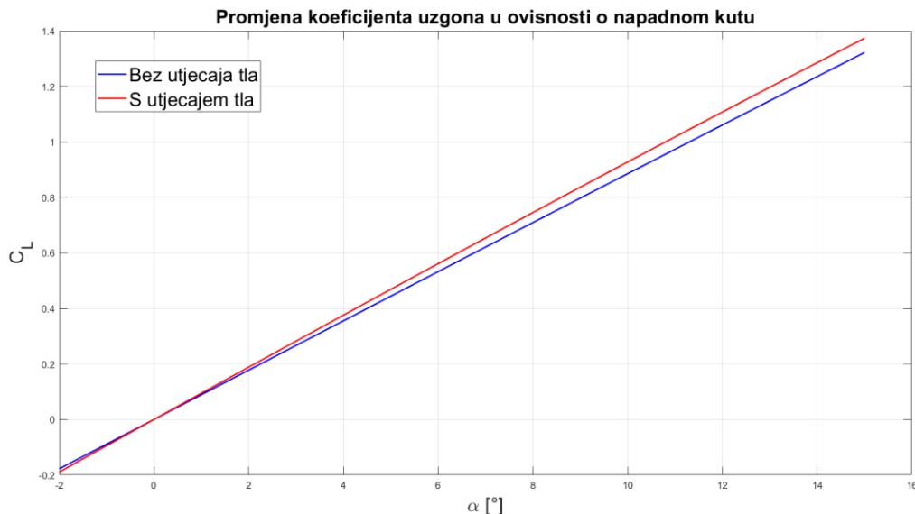
Slika 12 Usporedba promjene koeficijenta uzgona u ovisnosti o napadnom kutu  $\alpha$  sa i bez utjecaja tla za visinu  $h=0.5$  m
