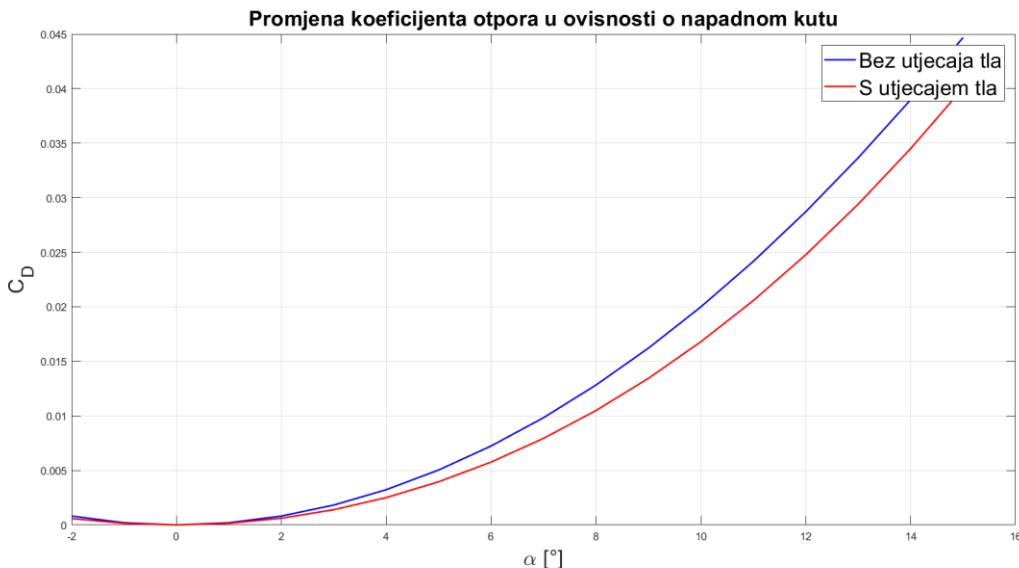
Slika 10 Promjena koeficijenta otpora u ovisnosti o napadnom kutu  $\alpha$  za visinu leta  $h=0.5$  m
