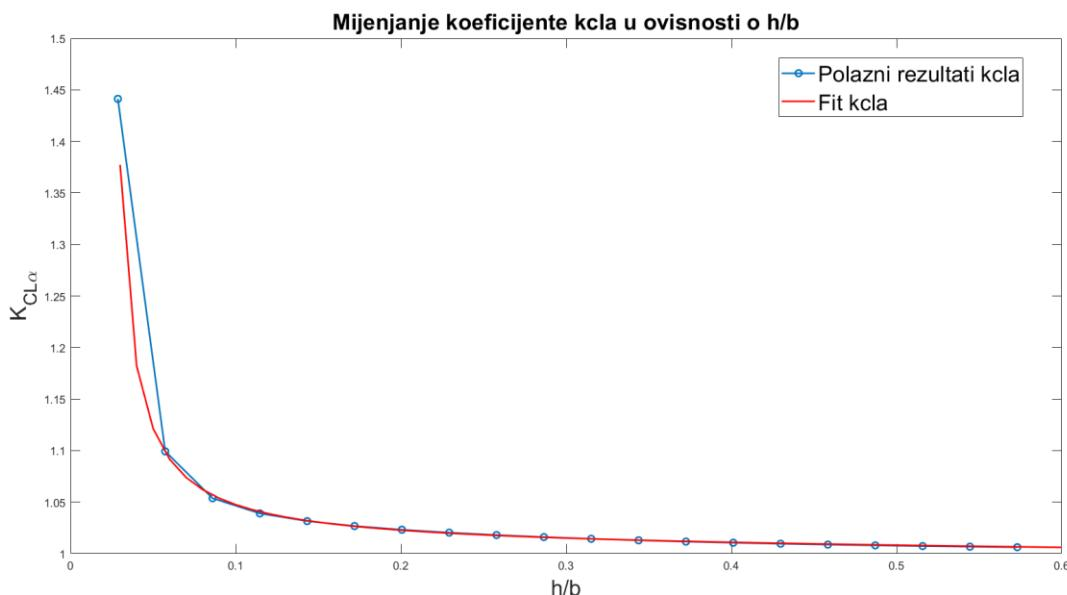
Slika 14 Mjenjanje koeficijenta kcla u ovisnosti o h/b
