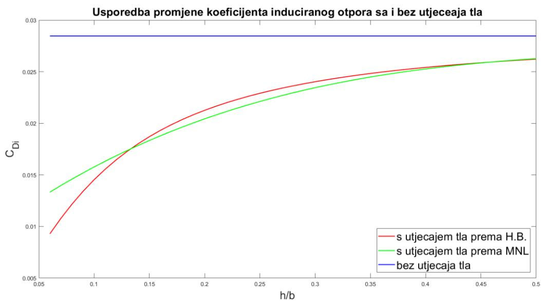
**Slika 17 Usporedba promjene koeficijenta induciranih otpora u ovisnosti o  $h/b$**
