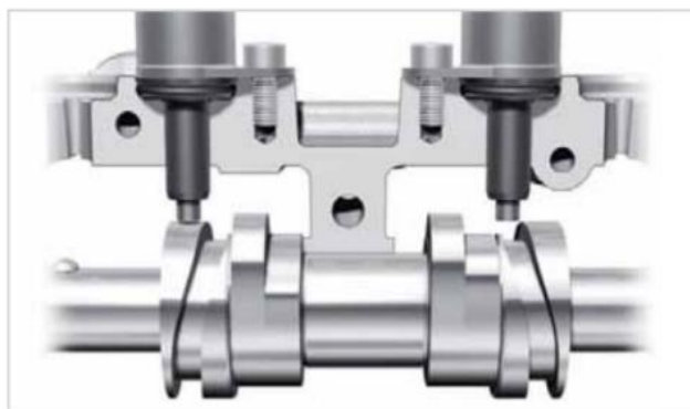
Slika 6. Sustav s pomičnim brijegom bregastog vratila [4]
