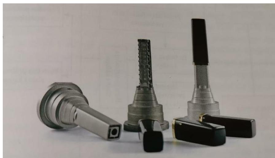
**Slika 11. Prototip žiga za proizvodnju poklopca ruža za usne [11]**
