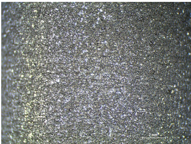
Slika 21. Legura Ti6Al4V proizvedena EBM postupkom u neobrađenom stanju, povećanje x7,33
