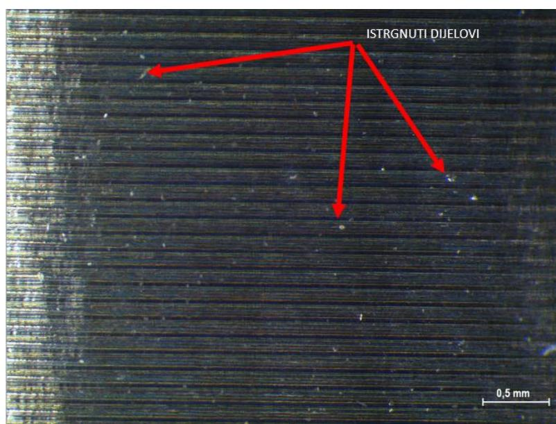
Slika 22. Legura Ti6Al4V proizvedena EBM postupkom nakon finog tokarenja, povećanje x31,3
