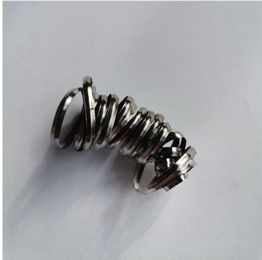
**Slika 8. Kontinuirano odvojena čestica konvencionalno proizvedene Ti6Al4V legure**
