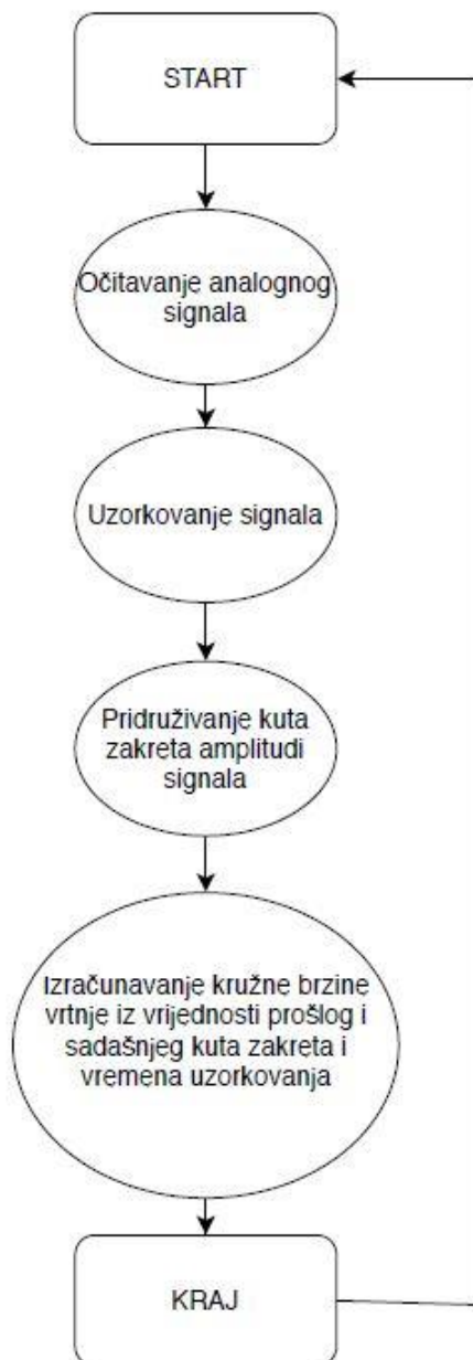
Slika 32. Algoritam za mjerenje brzine vrtnje vratila elektromotora
