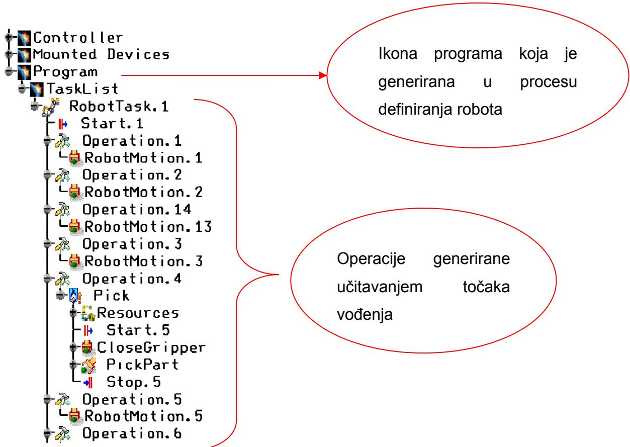
Slika 84. Robotski program generiran učitavanjem točaka vođenja
