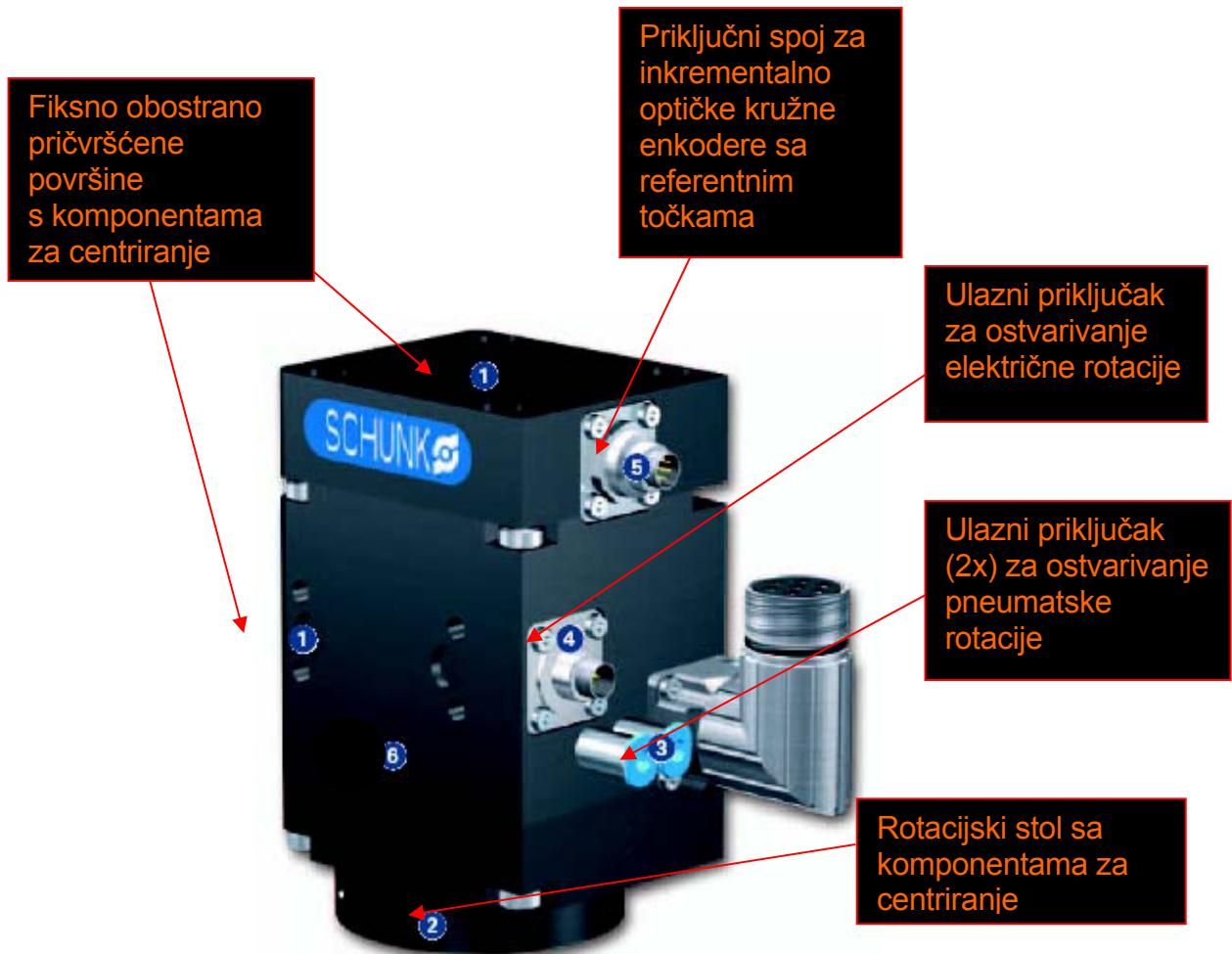
Slika 43. Komponente Torque motora Lirax – M RD [16]
