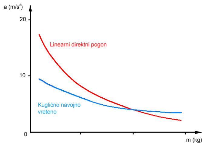
Slika 31. Usporedba ubrzanja u ovisnosti o pokretanim masama [13]
