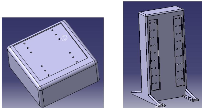
Slika 45. Elementi izrađeni lijevanjem Sivog lijeva SL 30
