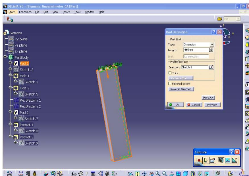
Slika 59. Kreiranje 3D oblika u Mechanical Design – Part Design modulu
