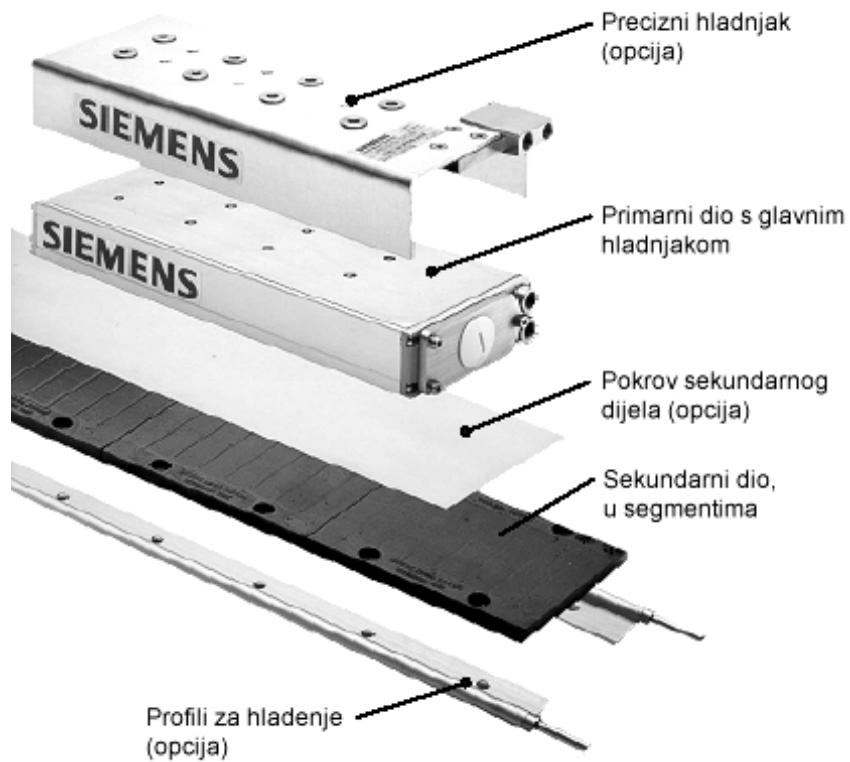
Slika 29. Odabrani Linearni motor i njegovi osnovni dijelovi [13]
