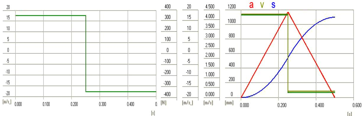
Slika 35. Dijagram ubrzanja LM i kumulativni dijagram [14]
