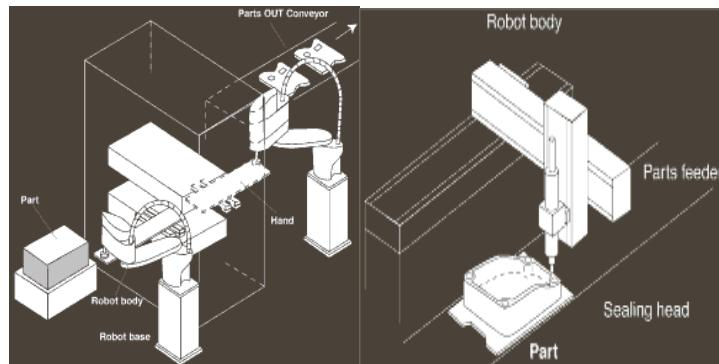
Slika 17. Prikaz različitih primjena SCARA robota [8]
