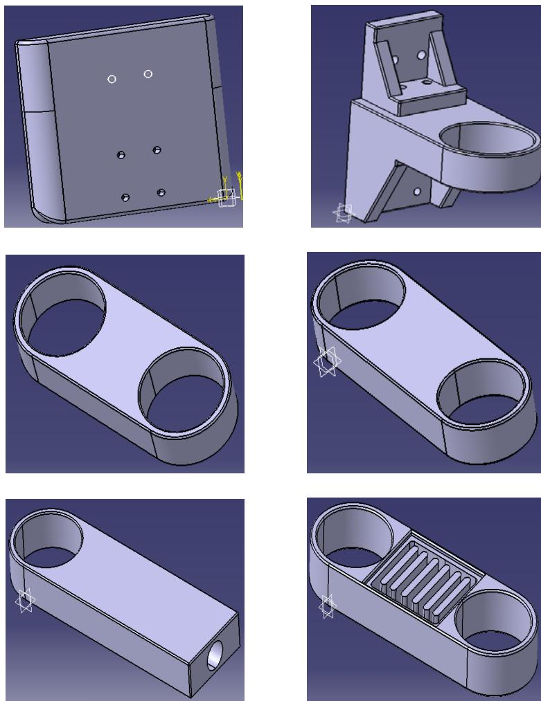
Slika 46. Elementi izrađeni od čelika Č 0361
