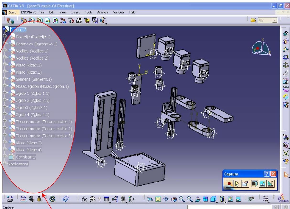
Grana koja pokazuje (navedene) komponente SCARA robota
