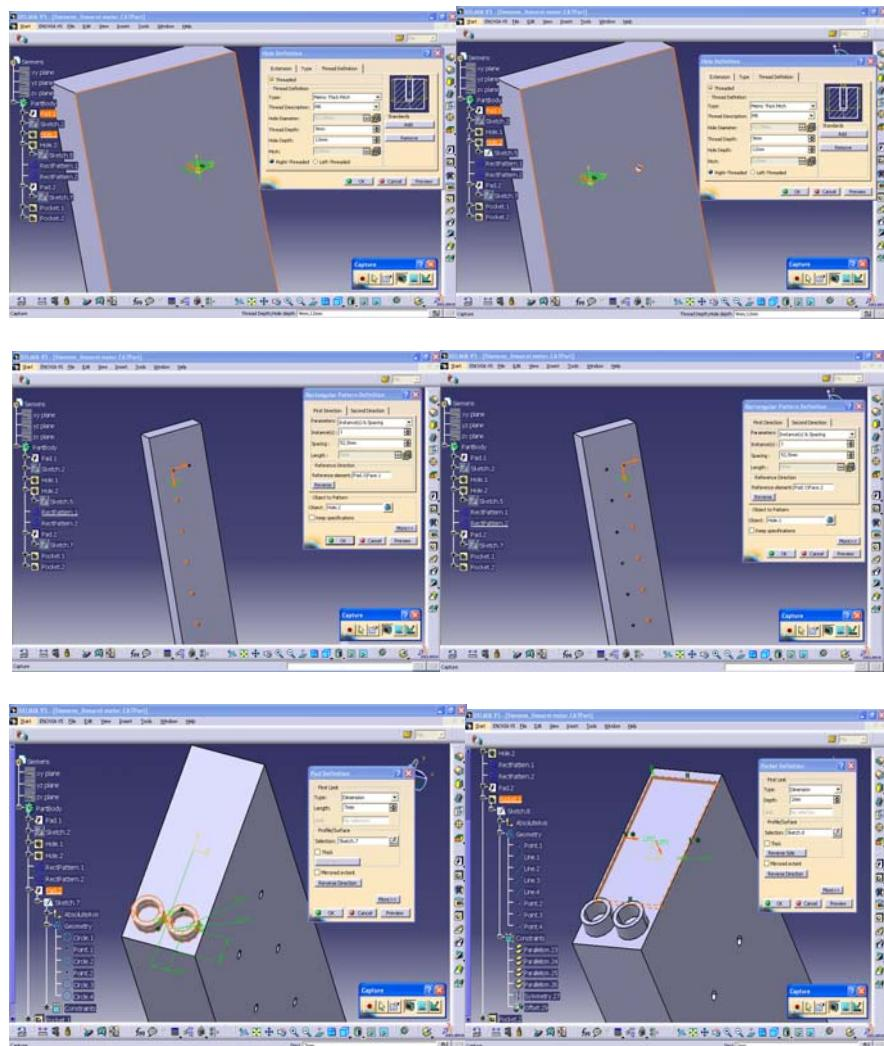
Slika 60. Modeliranje 3D oblika – Primarni dio Siemens LM s glavnim hladnjakom
