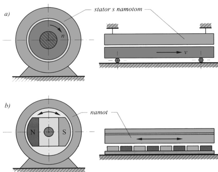
Slika 26. Prikaz nastanka linearog motora iz rotacijskog:
