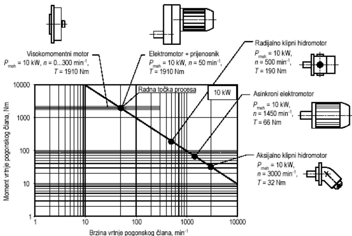
Slika 38. Prilagodba pogona radnoj točki procesa [15]
