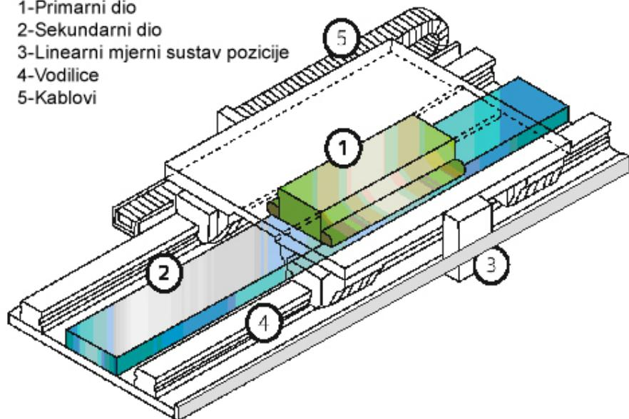
Slika 28. Pogon s linearnim motorom – dijelovi [13]
