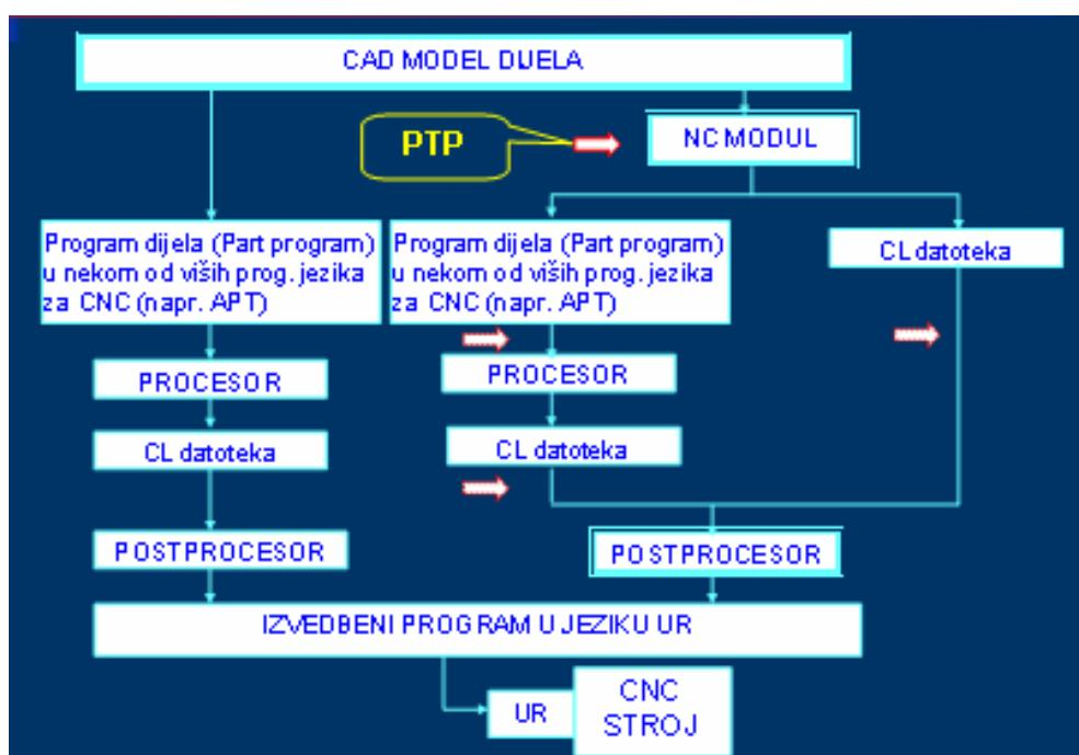
Slika 8. Programiranje CNC strojeva u CAD/CAM sustavima [4]
