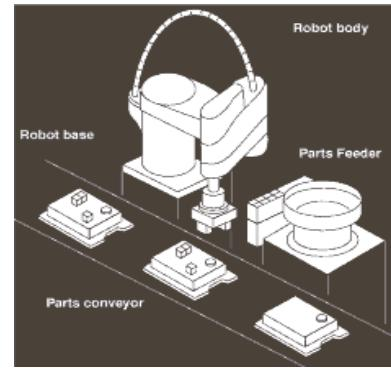
Slika 16. Prikaz posluživanja obradnog centra SCARA robotom [8]
