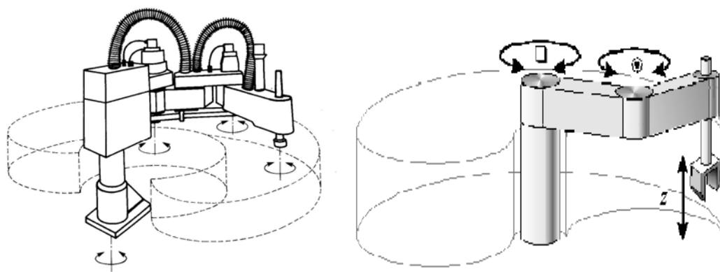
Slika 18. Radni prostor SCARA robota [3]
