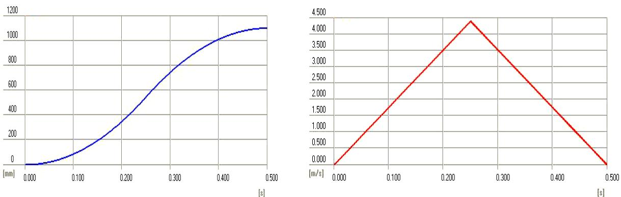
Slika 34. Dijagrami puta i brzine za linearni motor [14]
