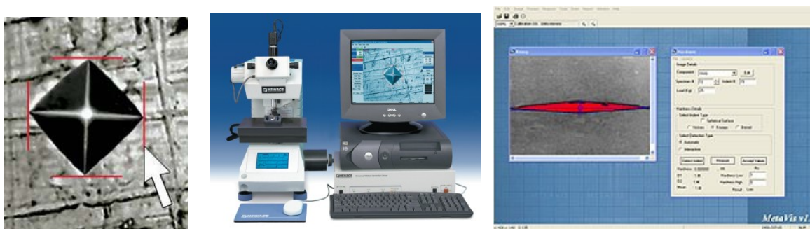
Slika 12. Mjerenje dijagonale otiska uz pomoć računala [16]
