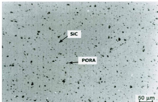
**Slika 25.** Mikrostruktura silicijeva karbida sinteriranog bez tlaka
