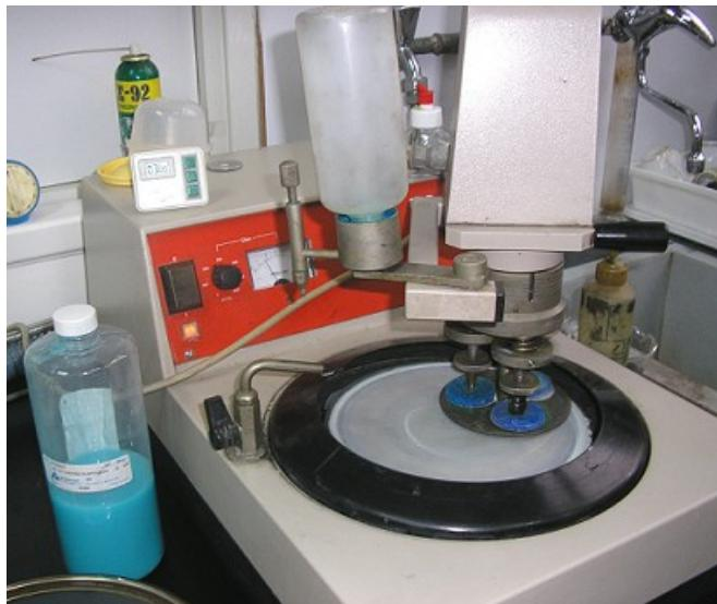
**Slika 37.** Poliranje uzorka
