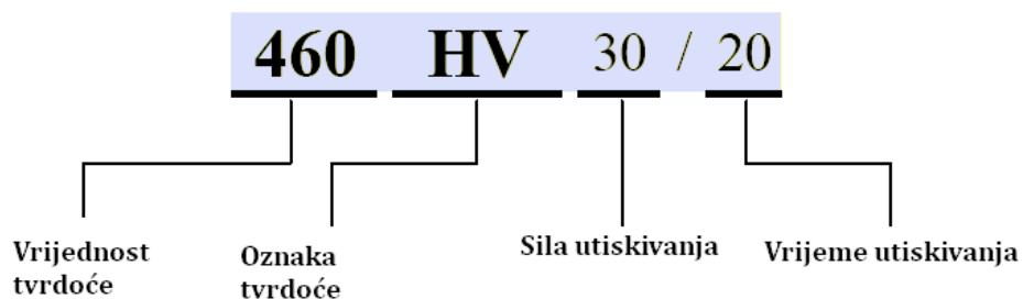
Ispitivanje tvrdoće po Vickersu propisano je, temeljem Zakona o normizaciji, normom HRN EN ISO 6507-1:2000 [6].
