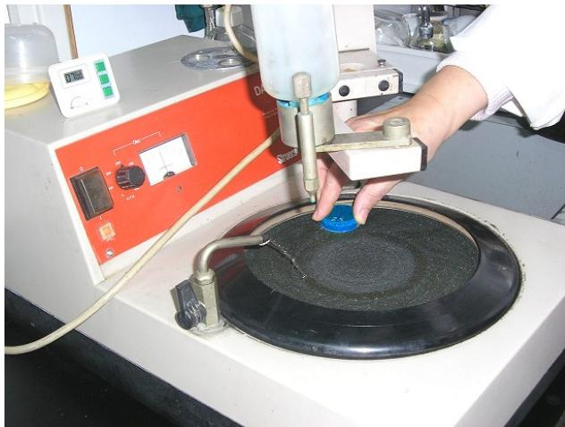
**Slika 36.** Brušenje uzorka
