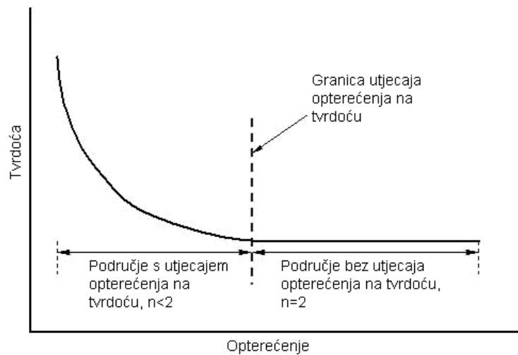
**Slika 15.** Shematski prikaz utjecaja opterećenja na tvrdoću [20]
