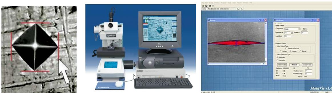
Slika 12. Mjerenje dijagonale otiska uz pomoć računala [16]
