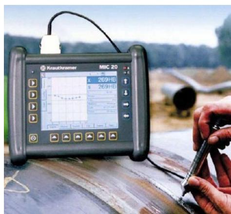
**Slika 5.** Uređaji za mjerjenje tvrdoće po Vickersu [2]
