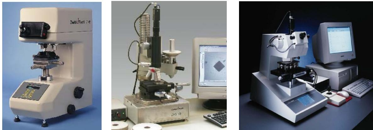
**Slika 11.** Uređaji za mjerjenje Knoopove tvrdoće [15]
