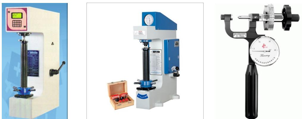
**Slika 8.** Uređaji za mjerjenje tvrdoće po Rockwellu [10] i [11]
