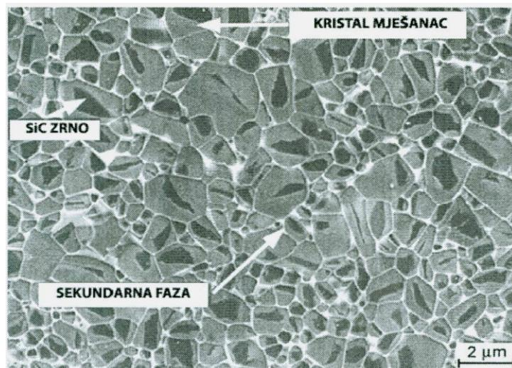
**Slika 24.** Mikrostruktura silicijeva karbida sinteriranog u prisustvu tekuće faze
