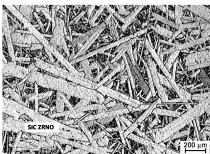
**Slika 26.** Mikrostruktura grubozrnatog silicijeva karbida sinteriranog bez tlaka
