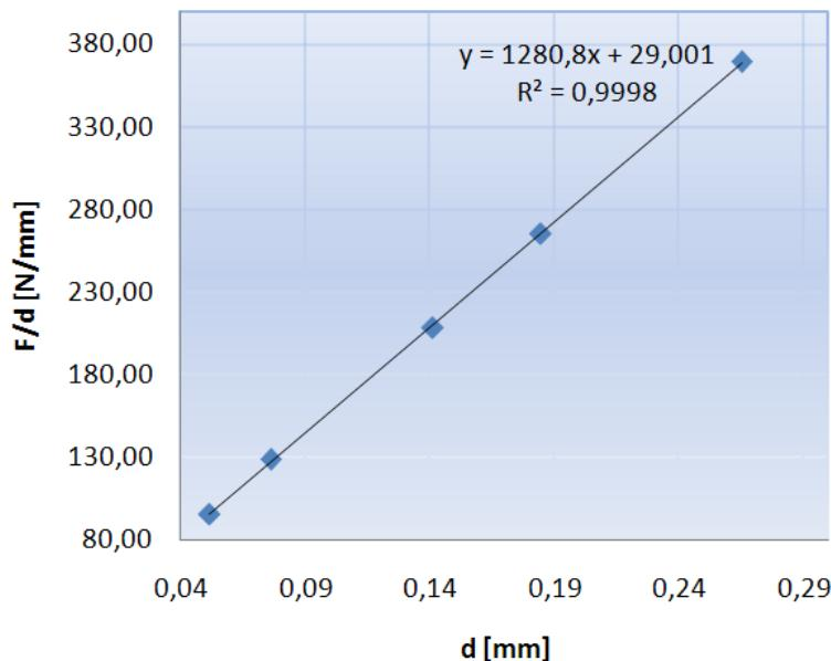
**Slika 55.** Grafički prikaz ovisnosti  $F/d$  o  $d$  za SiC keramiku prema modelu otpornosti razmjernom svojstvima uzorka
