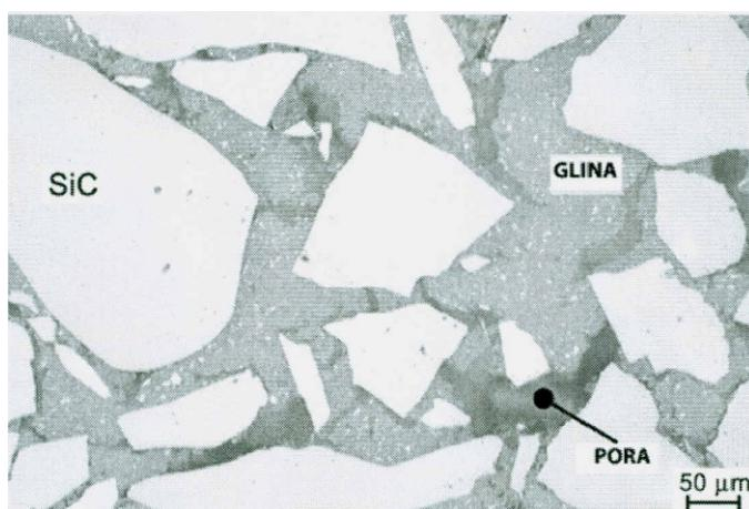
**Slika 22.** Mikrostruktura grubozrnatog silicijeva karbida povezanog silikatima
