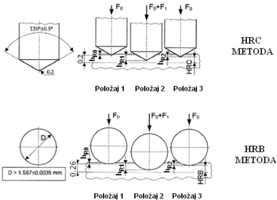
**Slika 7.** Shematski prikaz postupka mjerjenja [9]
