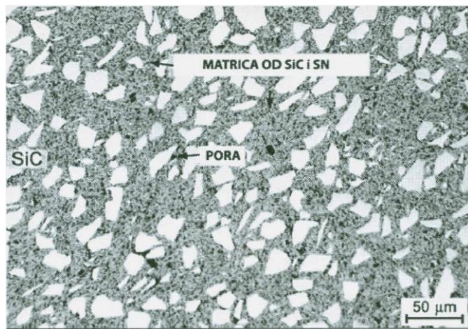
**Slika 30.** Mikrostruktura silicijeva karbida povezanog nitridom [24]
