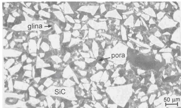
**Slika 23.** Mikrostruktura sitnozrnatog silicijeva karbida povezanog silikatima
