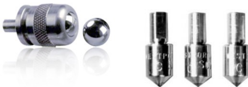
Slika 6. Prikaz kugličnog i dijamantnog penetratora kod Rockwellove metode [7]
