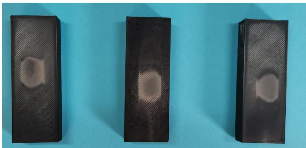
Slika 38 Uzorci serija 2 nakon prvog trošenja
