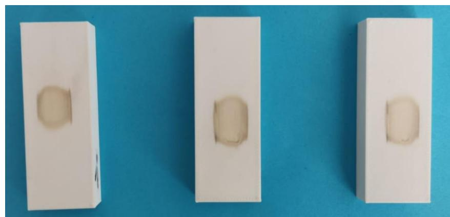
Slika 43 Uzorci serije 3 nakon prvog trošenja
