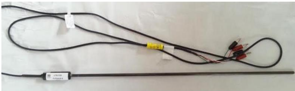
Slika 9. Otpornički termometri korišteni za umjeravanje kupke
