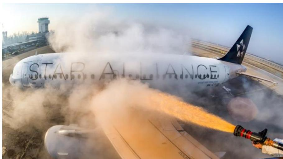
**Slika 4. Odleđivanje zrakoplova na zemlji<sup>3</sup>**
