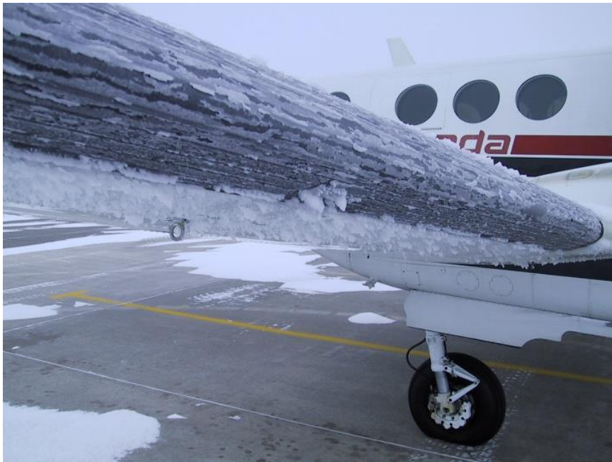
Slika 1. Nakupine leda na napadnom rubu krila 1
