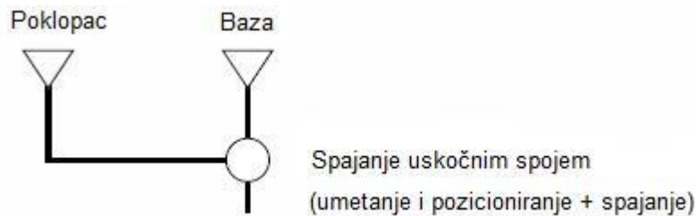
Slika 6. Istovremeno odvijanje operacija montaže
