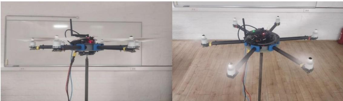
Slika 6.9: Testiranje konvencionalne konfiguracije sa 6 rotora.
