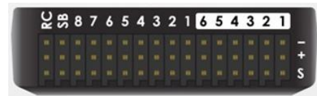
Slika 6.39: Izlazni portovi Pixhawk FC-a.
