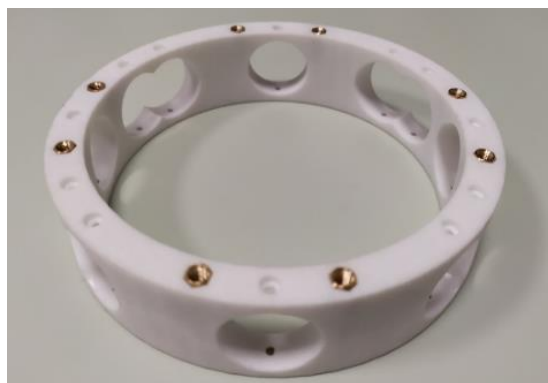
Slika 6.16: Unutarnji prsten s pričvrstnim elementima.
