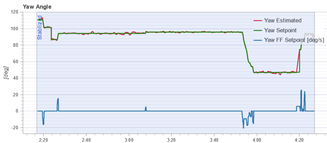
Slika 6.48: Odziv sustava – kut skretanja (yaw).
