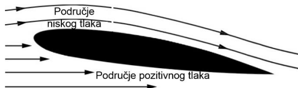
Slika 3.6: Aerodinamički oblik propelera.
