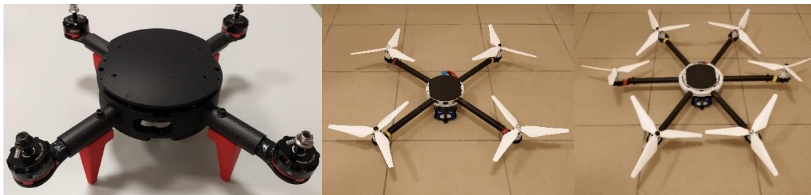
Slika 6.11: Moguće izvedbe pogonskog modula.
