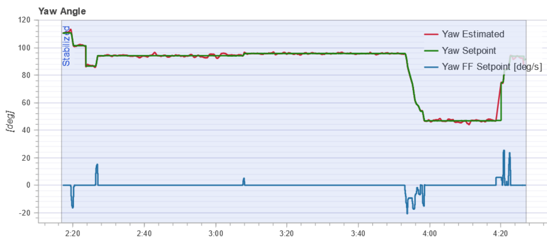
Slika 6.48: Odziv sustava – kut skretanja (yaw).
