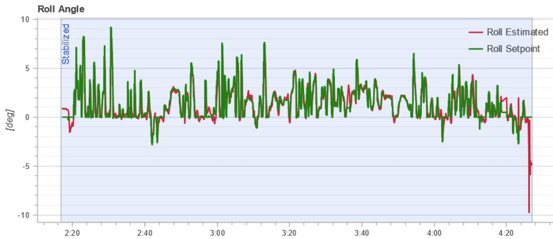
Slika 6.46: Odziv sustava – kut valjanja (roll).
