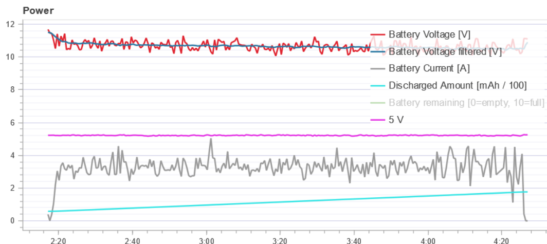
Slika 6.49: Električne veličine za vrijeme testnog leta.
