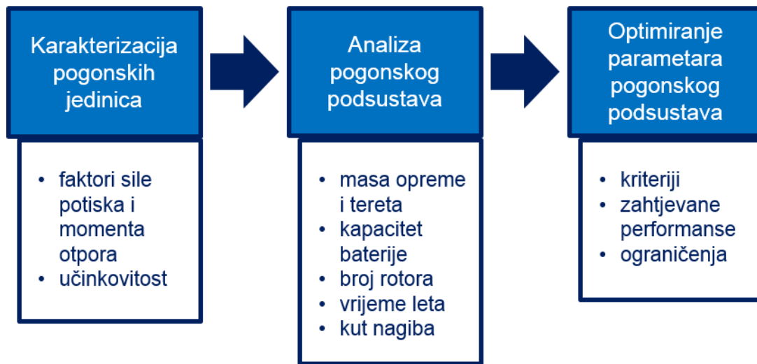
Slika 4.58: Metodologija za određivanje optimalnih parametara geometrijskog rasporeda pogonskog podsustava.
