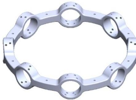
Slika 6.18.: 3D model vanjskog prstena - 8 rotora.
