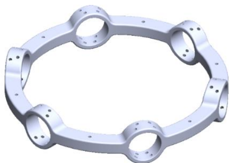
Slika 6.17: 3D model vanjskog prstena - 6 rotora.
