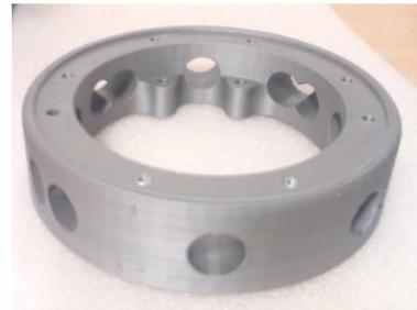
Slika 6.8: Prototip unutarnjeg prstena.
