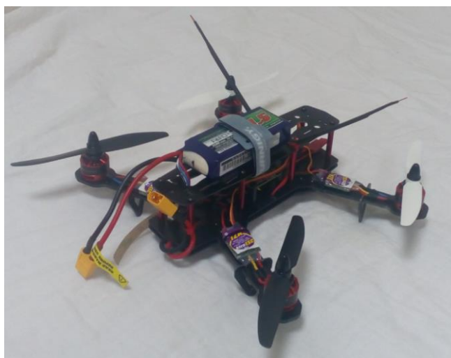
Slika 2.8: Letjelica s elektromotornim BLDC pogonom.
