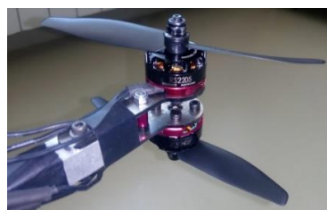
Slika 2.11: Koaksijalna izvedba pogona.
