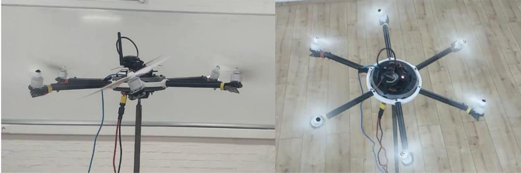
Slika 6.10: Testiranje potpuno upravljane konfiguracije sa 6 rotora.
