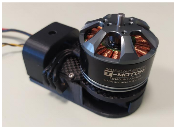
Slika 6.23: Sklop pogonske jedinice.
