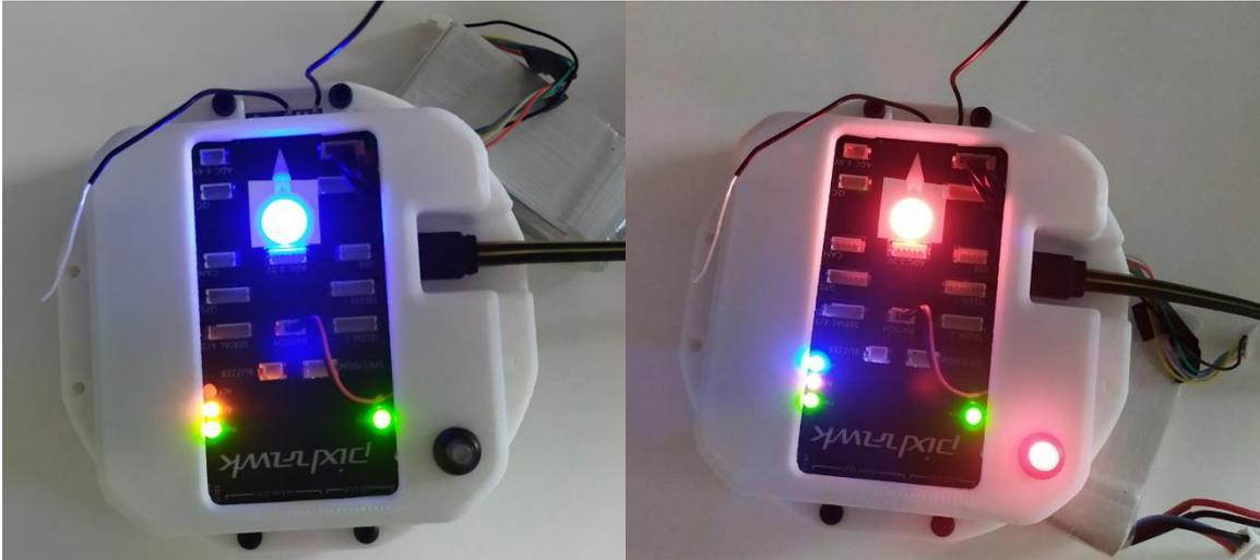
Slika 6.29: Prvo testiranje upravljačkog podsustava.
