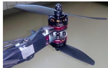
Slika 2.11: Koaksijalna izvedba pogona.
