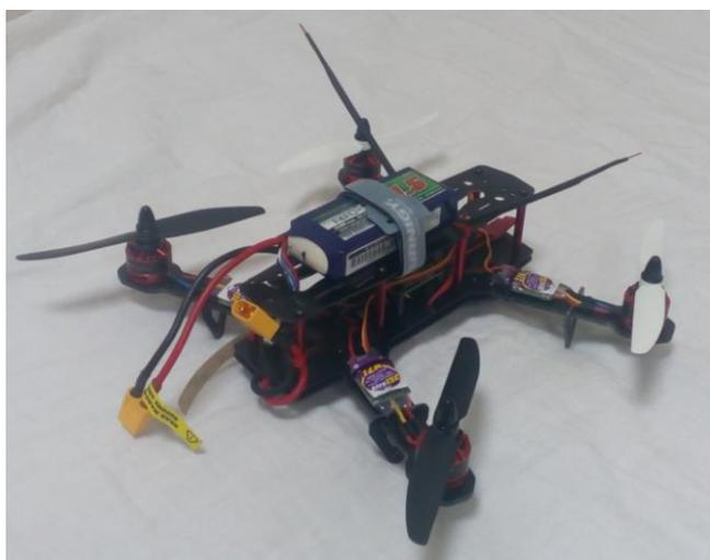
Slika 2.8: Letjelica s elektromotornim BLDC pogonom.
