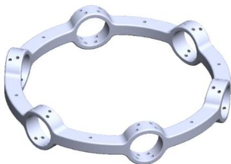
Slika 6.17: 3D model vanjskog prstena - 6 rotora.
