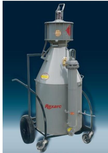
Slika 5. Prijenosni razvijač acetilena – šaržni postupak [8]
