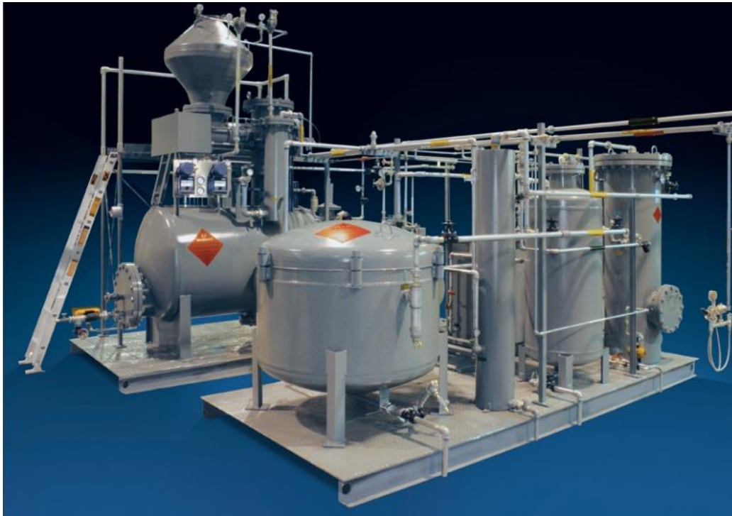
Slika 8. Pomično acetilensko postrojenje [8]
