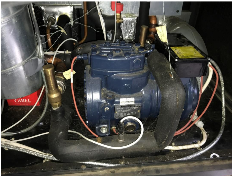
Slika 15. Kompresor Dorin ispitne dizalice topline
