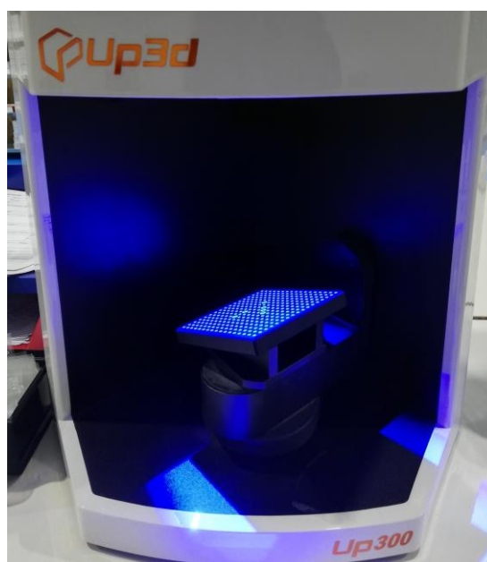
Slika 39. Skener UP300 za vrijeme kalibracije
