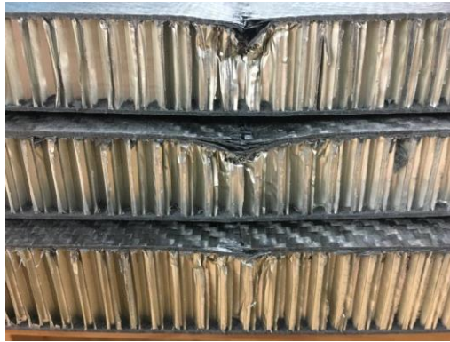
Slika 20. Ispitni uzorci nakon testiranja savijanja u tri točke [9]
