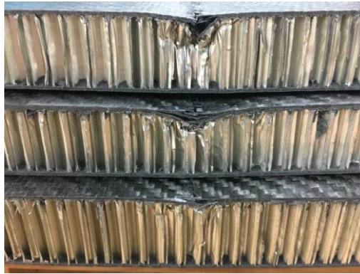
Slika 20. Ispitni uzorci nakon testiranja savijanja u tri točke [9]
