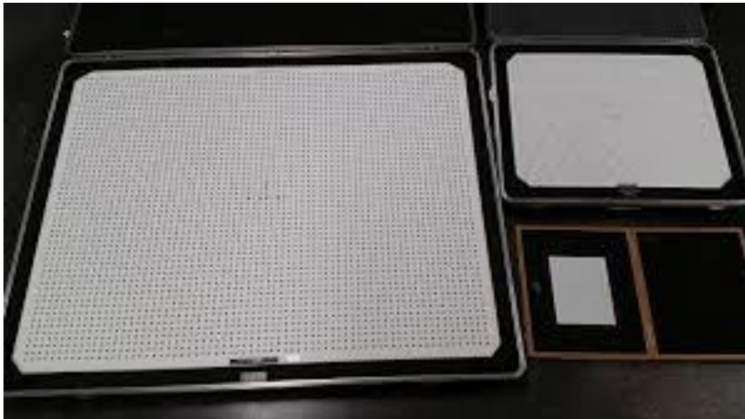
Slika 46. Kalibracijski 2D objekti
