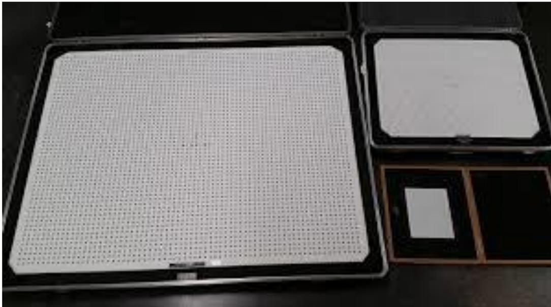
**Slika 46. Kalibracijski 2D objekti**
