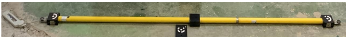
Slika 52. Mjerenje temperature mjerne letve
