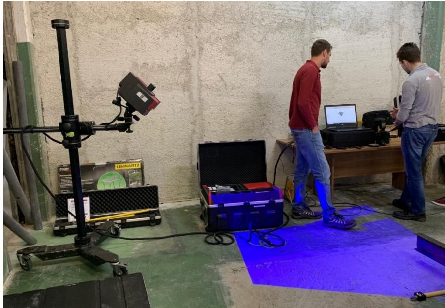
Slika 74. Zagrijavanje ATOS Triple Scan uređaja
