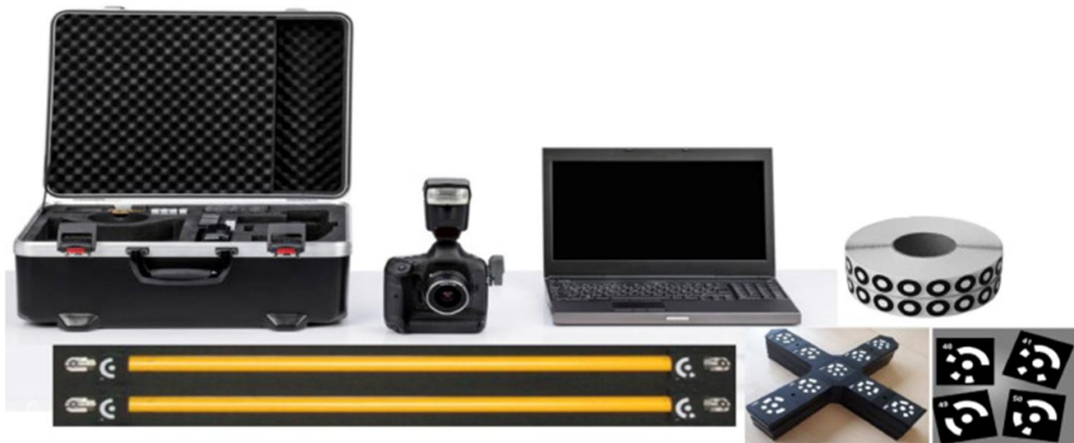
Slika 49. Cjelokupni TRITOP sustav
