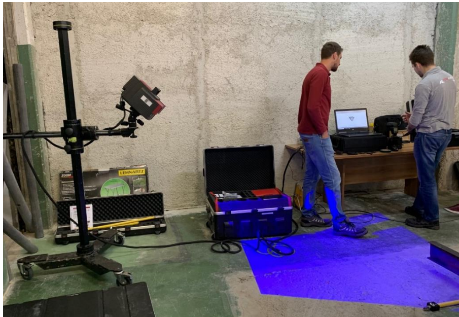
Slika 74. Zagrijavanje ATOS Triple Scan uređaja
