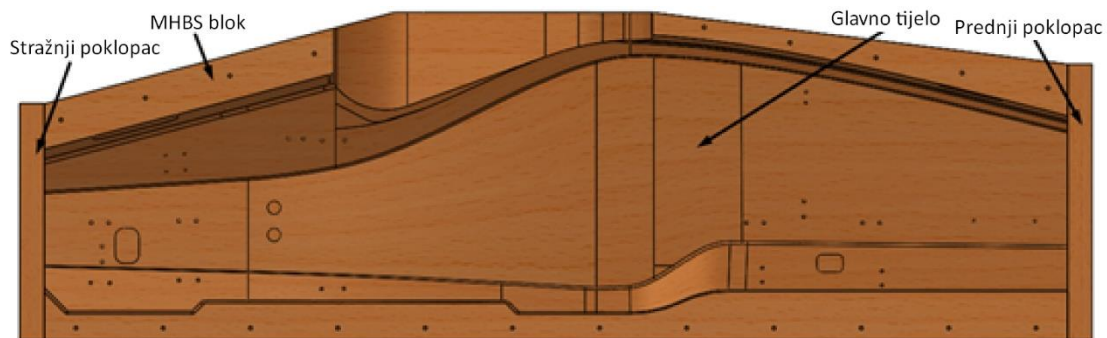
Slika 27. Model polovice kalupa za izradu monocoque -a
