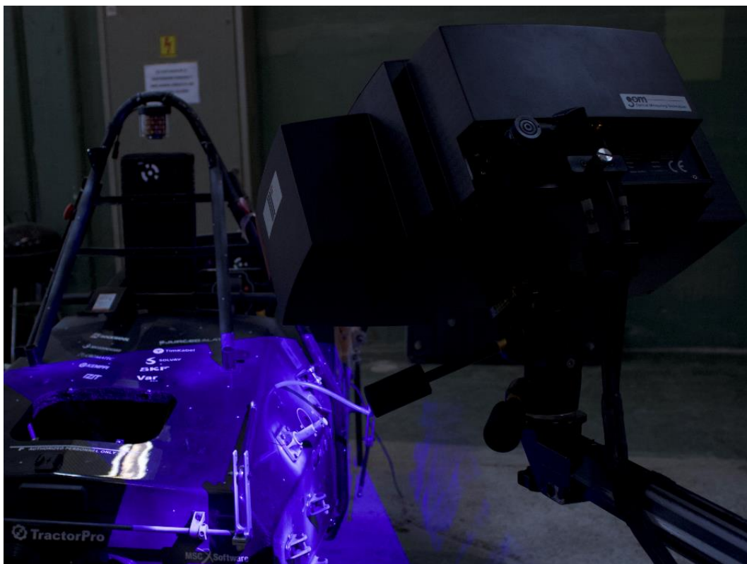
Slika 77. Proces skeniranja prihvata
