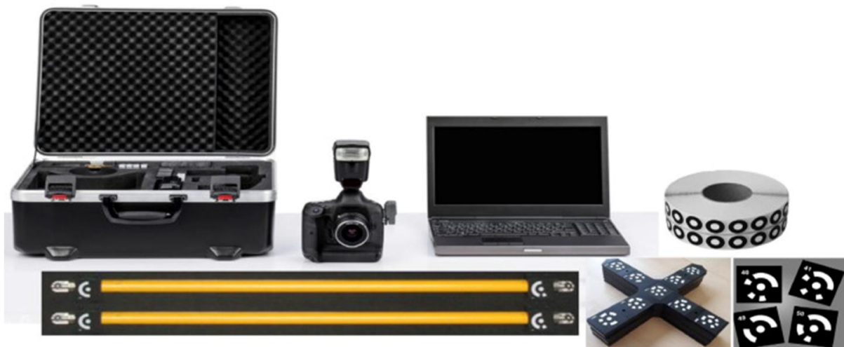
Slika 49. Cjelokupni TRITOP sustav
