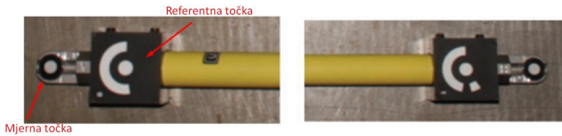
Slika 53. Detalj mjerne letve [13]
