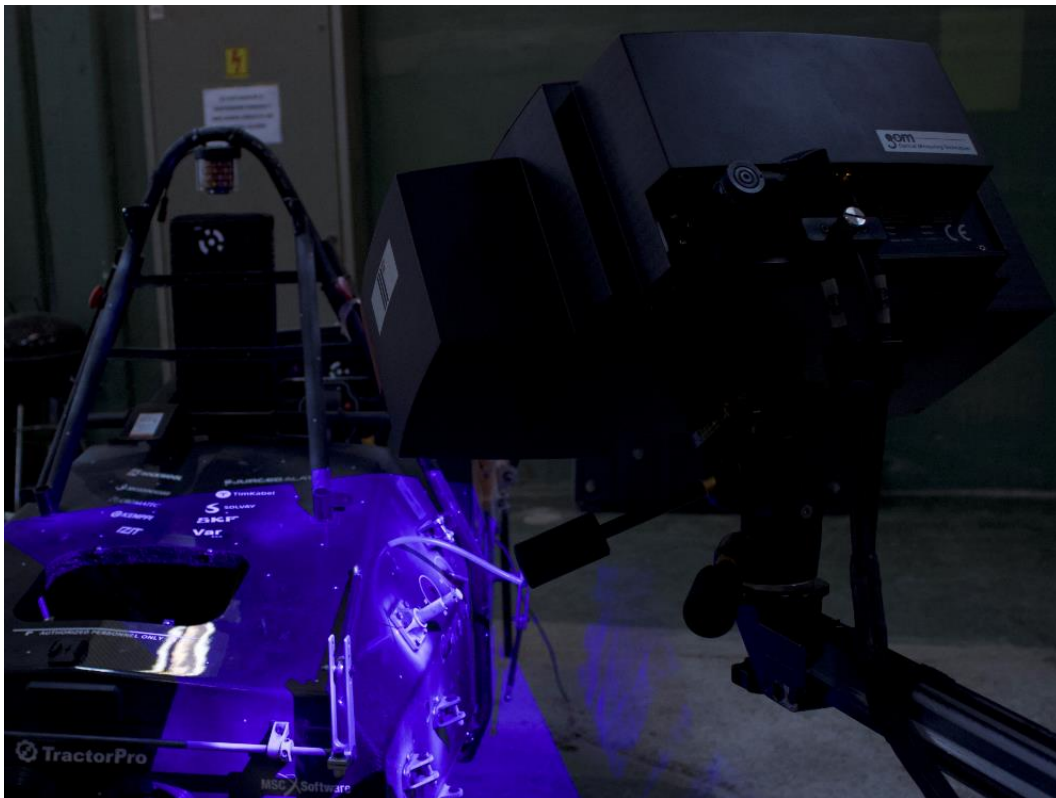
Slika 77. Proces skeniranja prihvata
