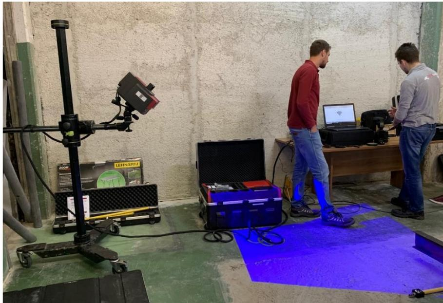
**Slika 74. Zagrijavanje ATOS Triple Scan uređaja**
