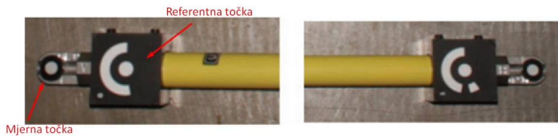
Slika 53. Detalj mjerne letve [13]
