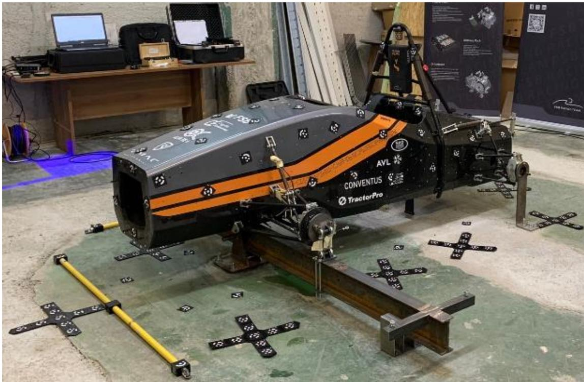
**Slika 55. Bolid pripremljen za referentno mjerenje**
