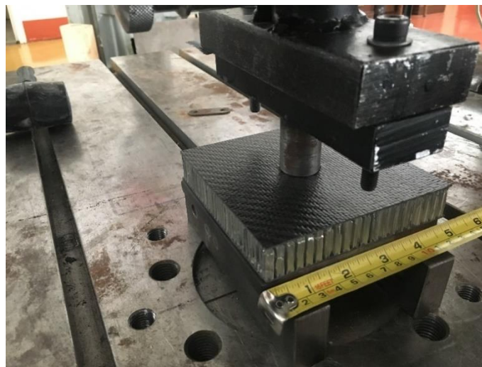
Slika 21. Perimeter Shear ispitni postav [6]
