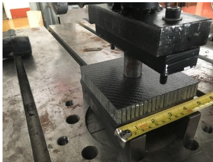
Slika 21. Perimeter Shear ispitni postav [6]
