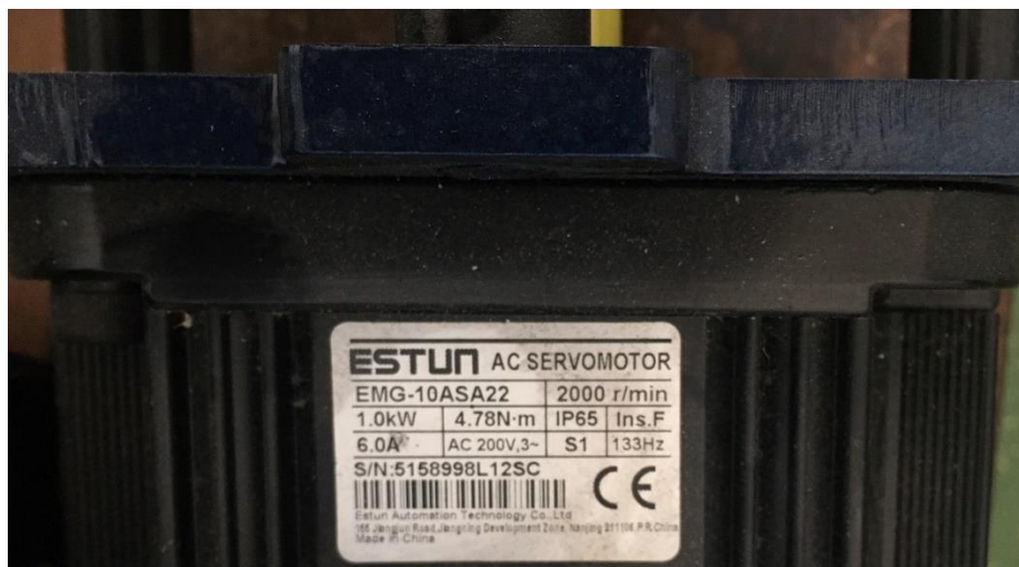
Slika 16. Natpisna pločica elektromotora X i Y osi
