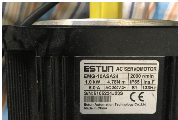
Slika 15. Natpisna pločica elektromotora Z-osi
