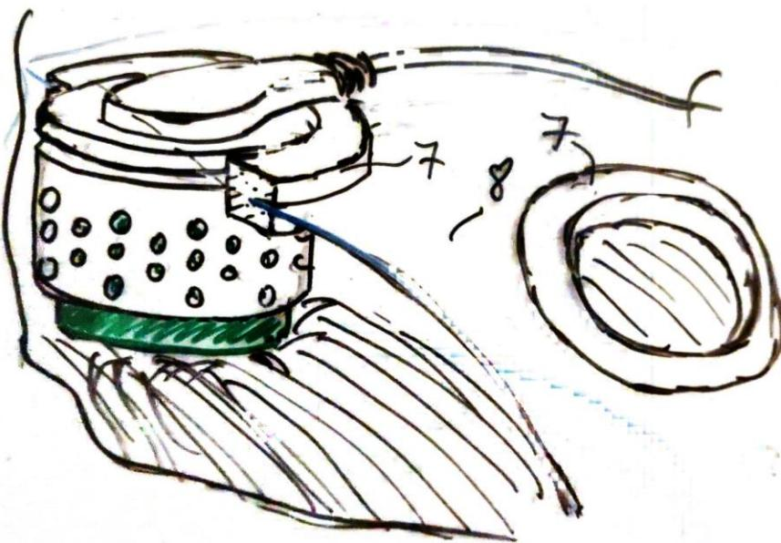
**Slika 11.5 Prikaz ostvarenog kontakta elektrode sa tjemenom pomoću EEG kape na jedan od načina na koji se senzor može ugraditi u standardne EEG kape**
