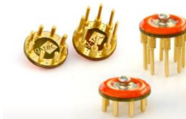
Slika 6.5 Suhe g.Tech SAHARA elektrode [109]
