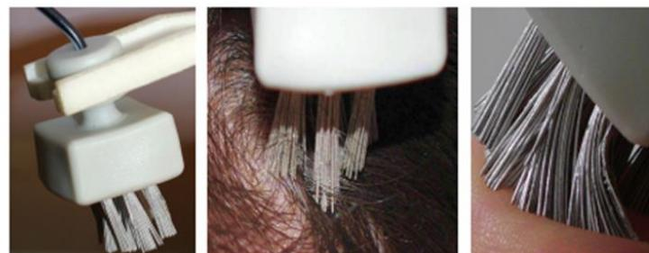
Slika 6.6 Prototip suhih elektroda s čekinjastim izdancima [110]
