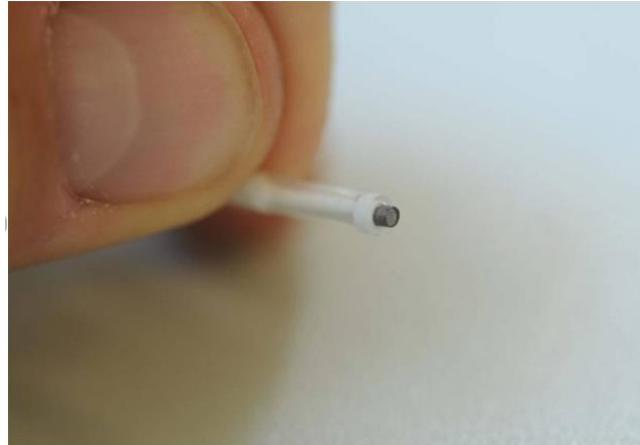
Slika 6.4 Prototip EEG elektrode na bazi vode [108]
