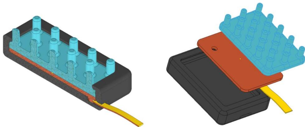
Slika 12.3 Presjek i ekspandirani prikaz predložene elektrode
