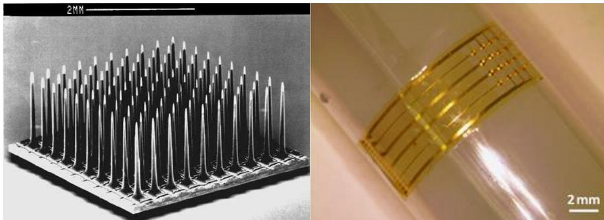
**Slika 4.1 (Lijevo)** Raster elektroda "Utah" (eng. Utah Electrode Array - UEA). Pokazuje 100 mikroelektroda u konfiguraciji 10 sa 10 koje izlaze iz baze od silikona. Svaka elektroda je odvojena od svojih susjeda 400  $\mu\text{m}$  i električno je izolirana od svojih susjeda staklenim snopom koji okružuje njezinu bazu. Svaka elektroda ima olovnu žicu vezanu za bazu [48].
