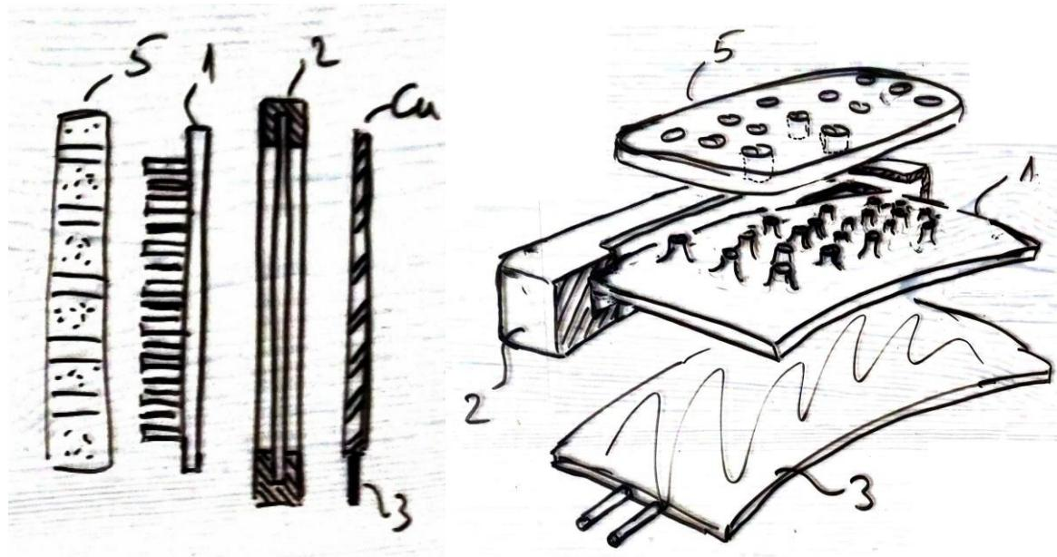
**Slika 11.8 Prikaz svih elemenata savitljivog senzora predloženog konceptom 2**
