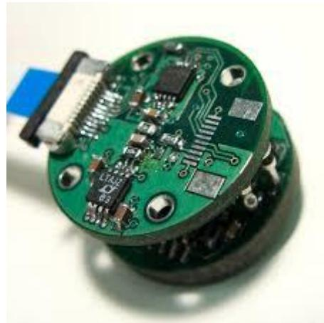
Slika 6.8 Beskontaktne EEG elektrode [111]
