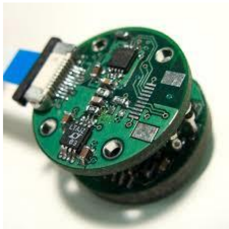
Slika 6.8 Beskontaktne EEG elektrode [111]
