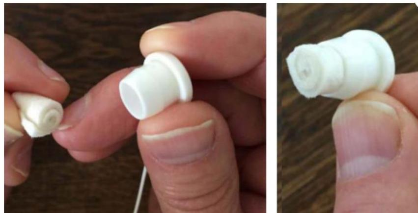
Slika 12.1 Prikaz Biopac elektroda [115]
