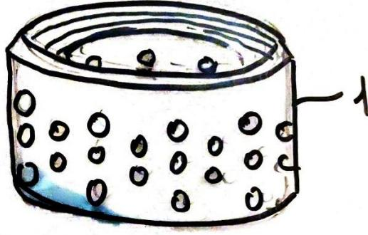
**Slika 11.3 Prikaz rupičaste strukture donjeg dijela kućišta senzora**
