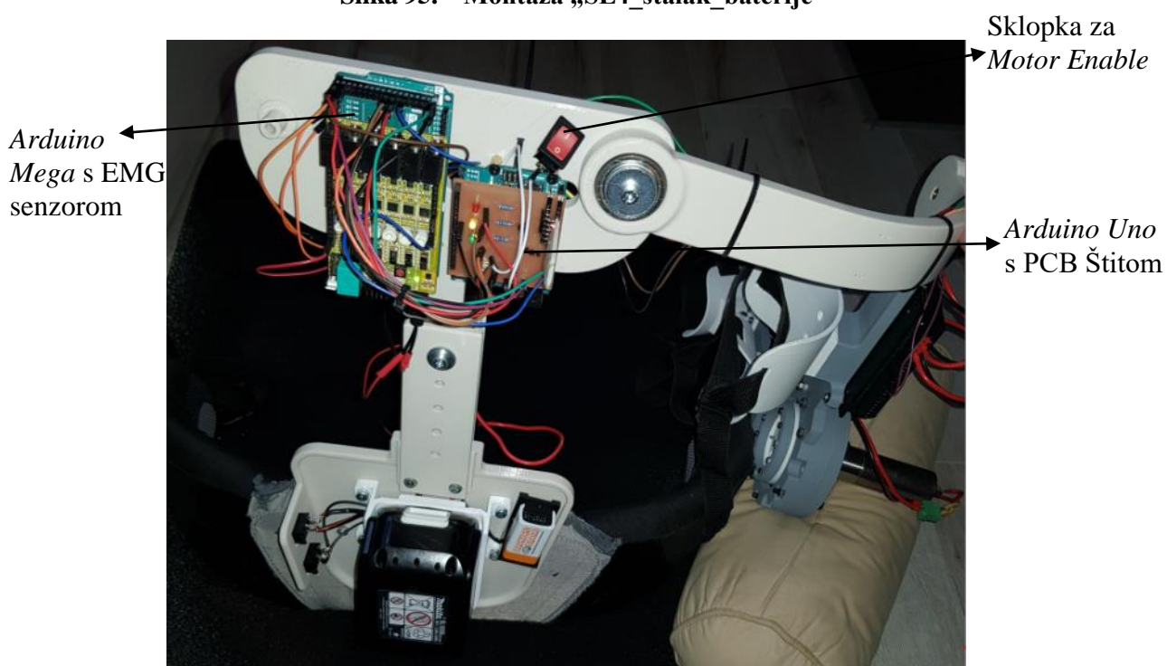
Slika 96. Montaža Arduino kontrolera „SL1_ploca_gore“
