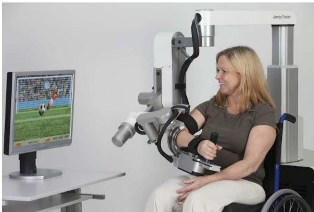
Slika 6. Fiksni egzoskelet za rehabilitaciju Armeo Spring [16]
