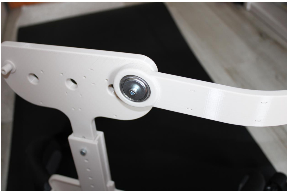
Slika 73. Pasivni zglob u spoju „Sklop_leda“ sa „Sklop_ruka_leda“
