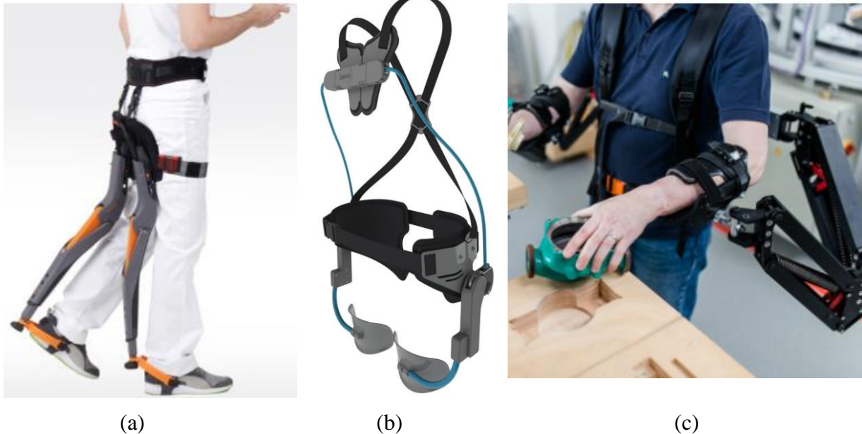
Slika 5. Pasivni egzoskeleti a) Noone [12], b) Laevo [13], c) RoboMate [14]
