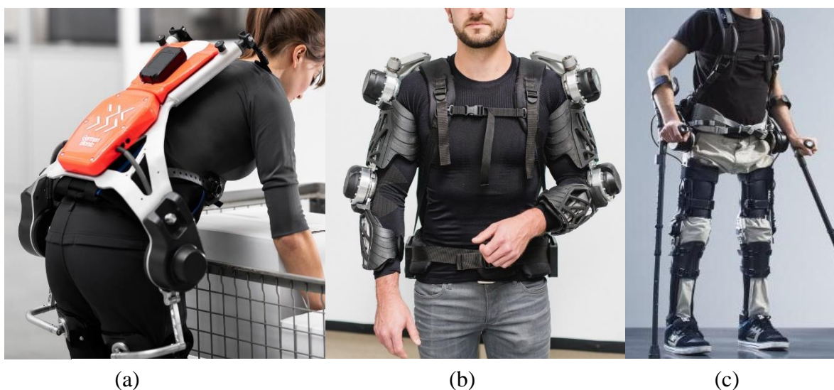
Slika 4. Aktivni egzoskeleti a) Cray [9], b) ExoJacket [10], c) SuitX [11]
