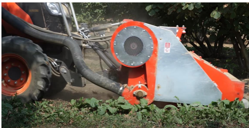
Slika 39. TR 200.2 - prikaz izlaznog crijeva za spremanje lješnjaka
