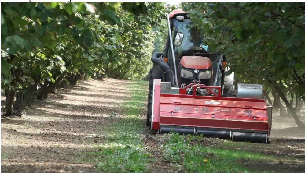
Slika 36. TR 200.2 - u radu uz primjenu bočnog pomaka
