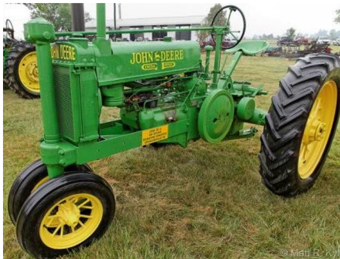
Slika 15. Traktor s benzinskim motorom i tri kotača [19]
