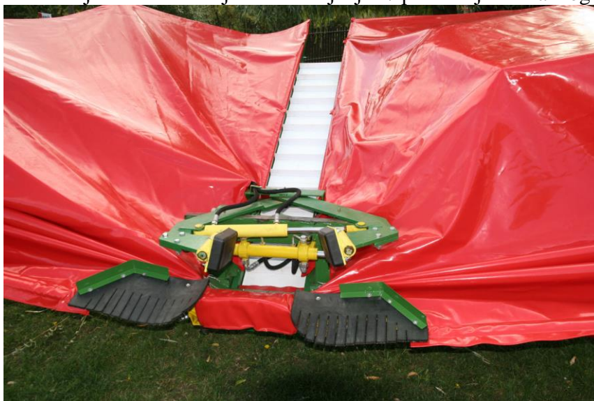
Slika 33. Model SP-05 - prikaz vibracijske glave, kišobrana i pokretne trake
