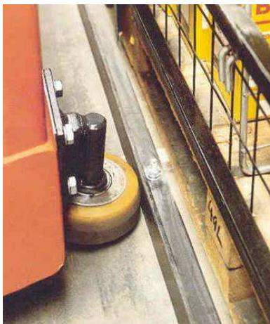
Slika 9. Mehanički sustav vođenja
